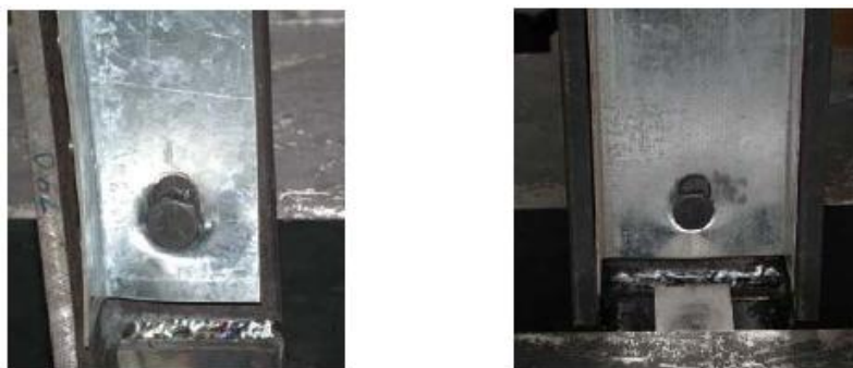
Figura 4.6 – Esmagamento da parede do furo em ensaio de Maiola (2004)
