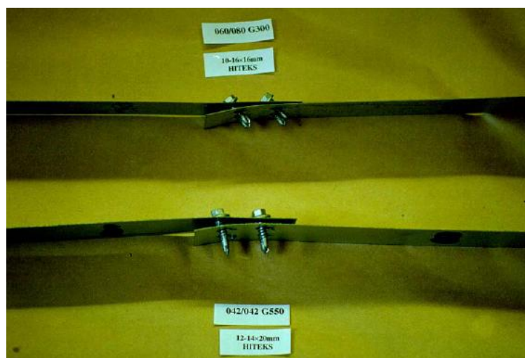
Figura 4.8 – Falha por esmagamento do furo/inclinação do parafuso em ligação com 4 parafusos dispostos em "quadrado" (Rogers e Hancock, 1997)
