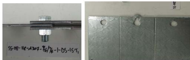
Figura 4.7 – Falha por rasgamento entre furo e borda da amostra SS-118-118-A307-9/16x3/4-1-DS-1.5-T1
