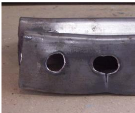
Figura 4.1 – ruptura da seção líquida ocorrida em duas cantoneiras com uma aba conectada (Paula, 2006)
