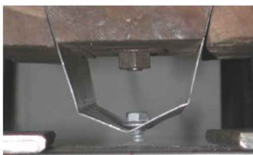
(a) arrancamento do parafuso
