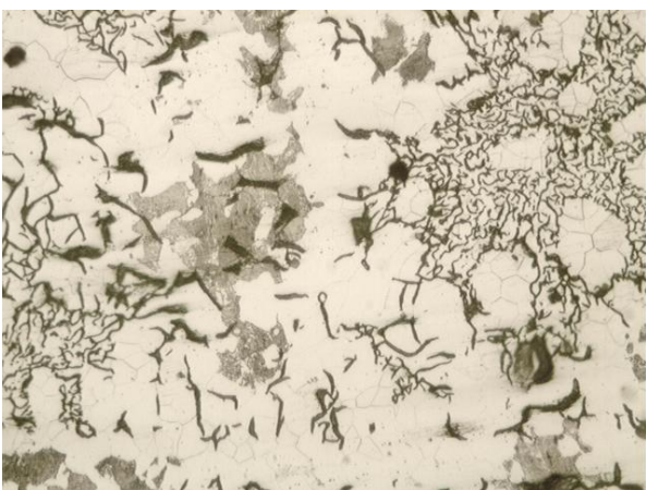
Figura 4. 75: Fotomicrografia ferro fundido cinzento; Ataque nital 2%; 400x
