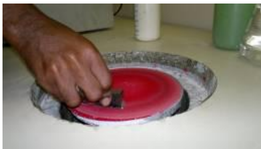
Figura 2. 135: Etapa de polimento de amostras. Fonte: Arquivo Pessoal
