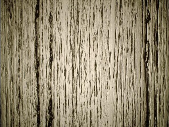
Figura 3. 91: Fotomicrografia da Amostra - ferro pudlado; seção longitudinal; Nital 2%; 50x.
