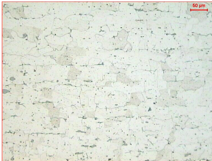
Figura 2. 136: Fotomicrografia da Amostra 01 - aço extra doce; Nital 2%; 200x
