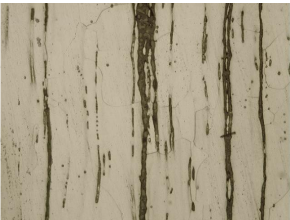
Figura 3. 93: Fotomicrografia da Amostra - ferro pudlado; seção longitudinal; Nital 2%; 400x
