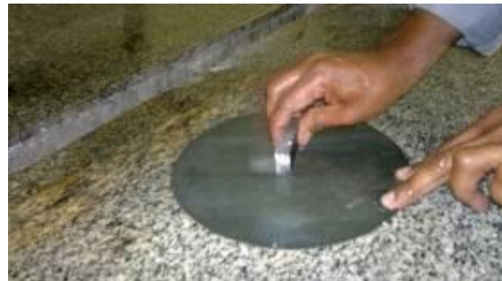
Figura 2. 134: Aplicação de lixa manual. Fonte: Arquivo Pessoal
