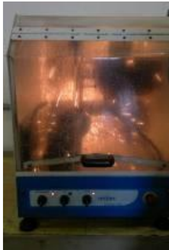
Figura 2. 132: Máquina Policorte para preparo de amostras. Fonte: Arquivo Pessoal
