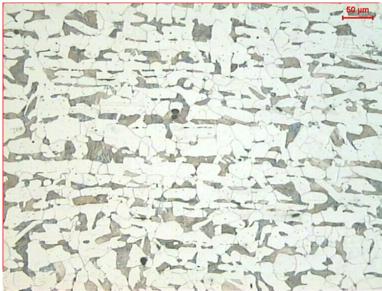
Figura 2. 141: Fotomicrografia da Amostra 05 - aço médio carbono; Nital 2%; 200x
