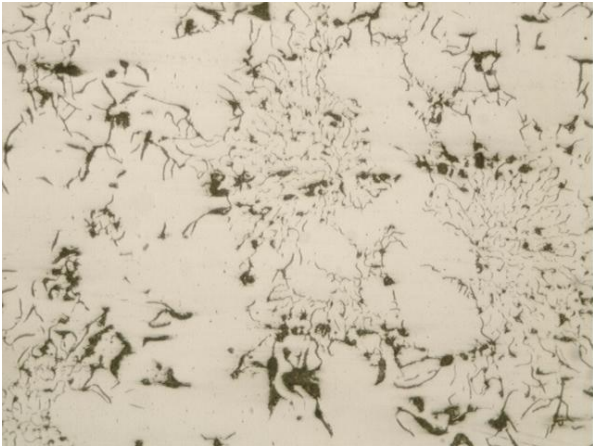
Figura 4. 73: Fotomicrografia ferro fundido cinzento; Sem ataque; 400x
