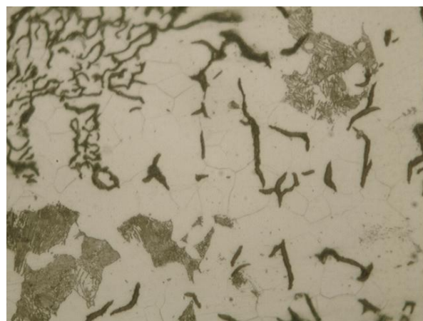
Figura 4. 76: Fotomicrografia ferro fundido cinzento; Ataque nital 2%; 800x
