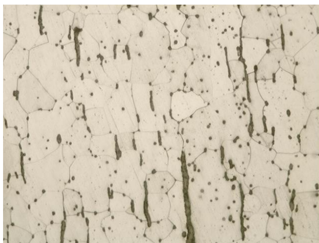
Figura 3. 95: Fotomicrografia da Amostra - ferro pudlado; seção transversal; Nital 2%; 400x
