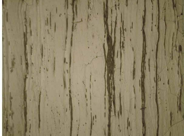
Figura 3. 92: Fotomicrografia Amostra - ferro pudlado; seção longitudinal; Nital 2%; 250x.
