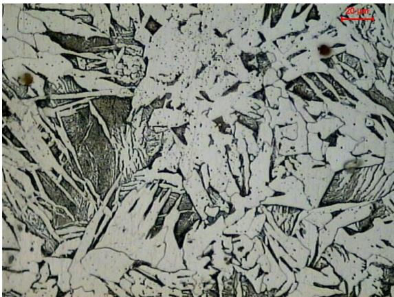
Figura 2. 139: Fotomicrografia da Amostra 04 – cabeça do rebite; Nital 2%; 500x.
