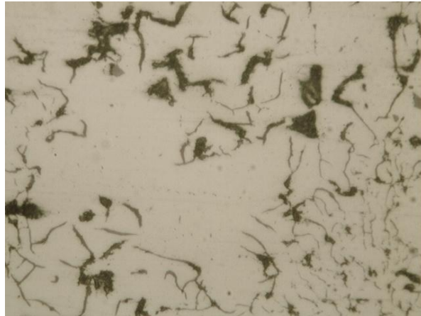
Figura 4. 74: Fotomicrografia ferro fundido cinzento; Sem ataque; 800x
