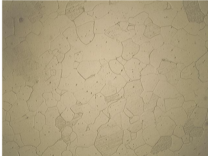
Figura 2. 138: Fotomicrografia da Amostra 03 - aço extra doce; Nital 2%; 250x
