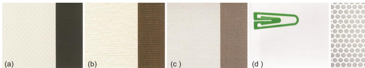
Figura 2.5-5 – Transmissão da luz de tecidos cobertos (a, b, c); filme ETFE (d)
