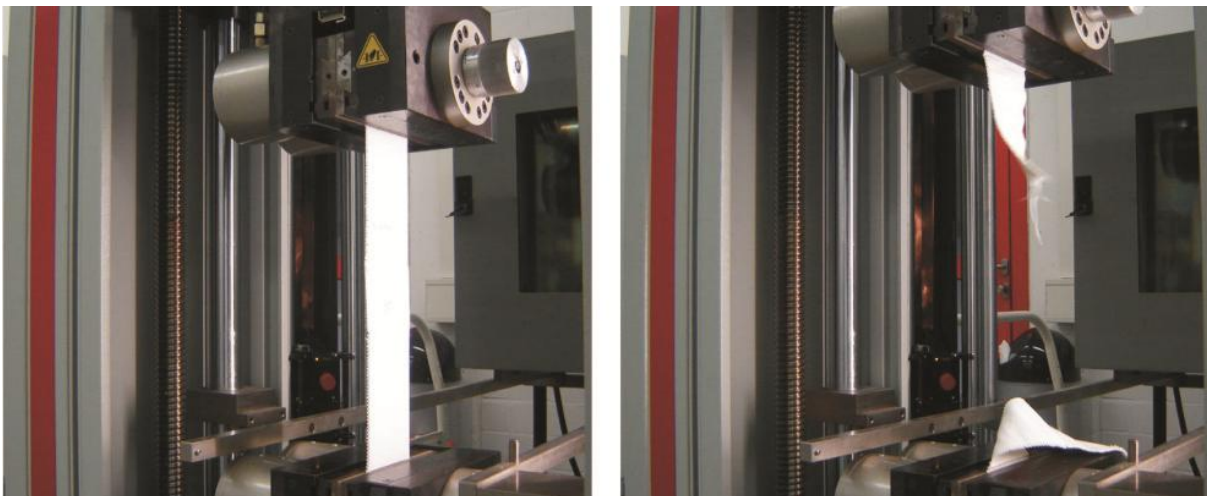
Figura 3.2-19– Teste uniaxial da união dos painéis, temperatura: + 23°C
