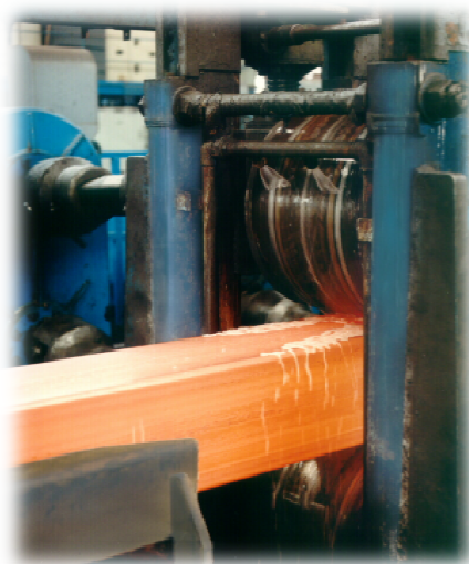
Figura 1.4 - Fabricação do Perfil RHS FONTE – CIDECT, 2010
