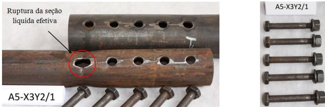
Figura 4.2 a – Protótipo A-5-X3Y2/1 após o ensaio.
