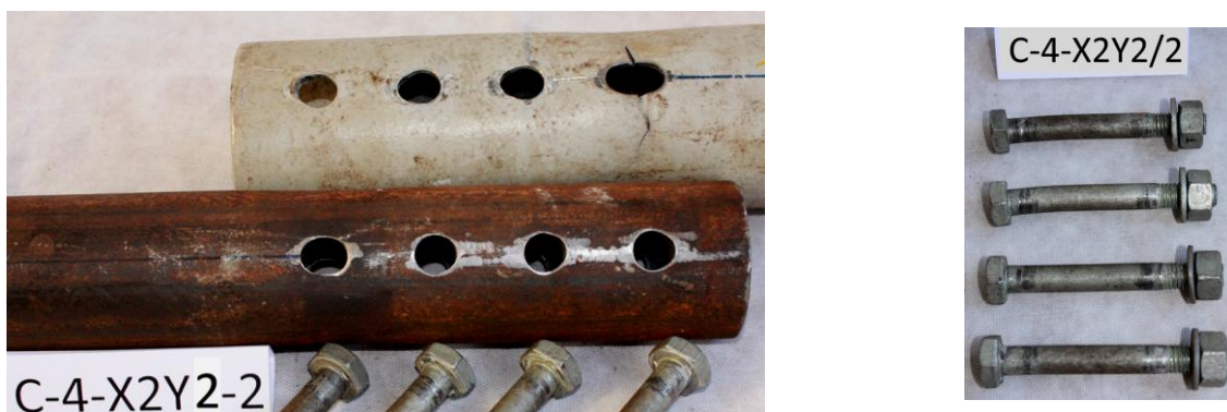
Figura 4.4 – Protótipo C-4-X2Y2/2 após o ensaio.
