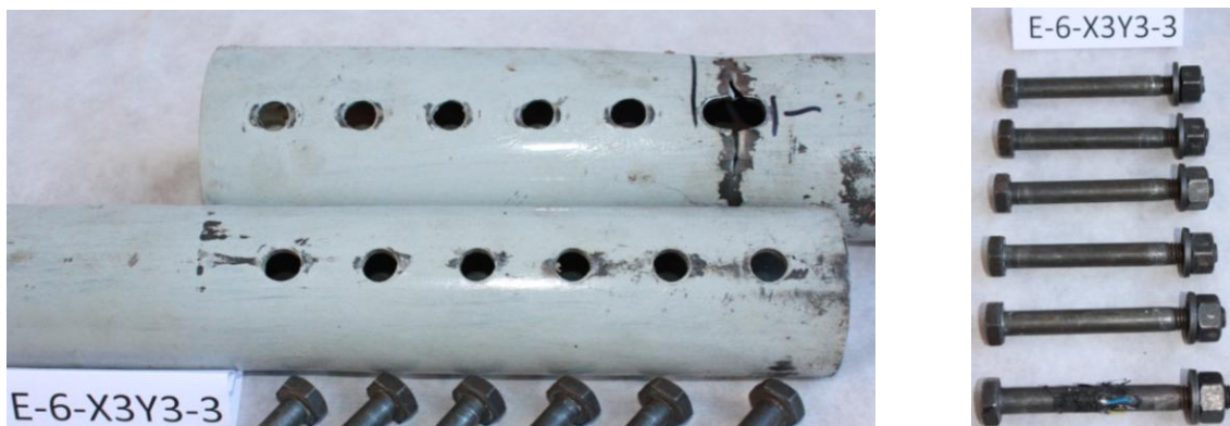
Figura 4.12 b – Protótipo instrumentado E-6-X3Y3/3 após o ensaio.
