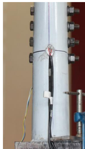
Figura 3.14.a e b – Posicionamento dos extensômetros elétricos nos tubos.
