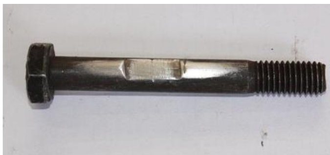
Figura 3.11 – Parafuso após lixamento para colocação dos extensômetros.
