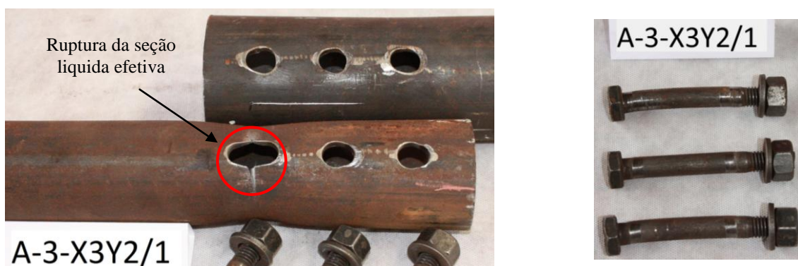
Figura 4.2 c – Protótipo A-3-X3Y2/1 após o ensaio.
