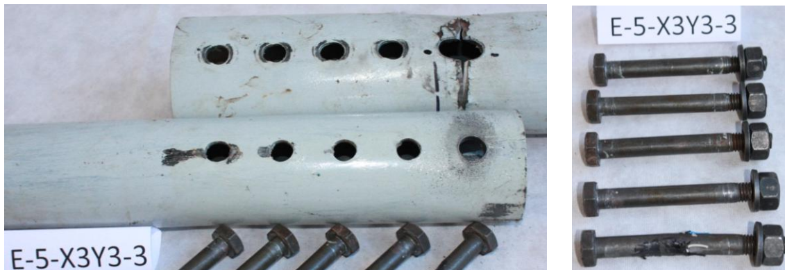
Figura 4.12 a – Protótipo instrumentado E-5-X3Y3/3 após o ensaio.
