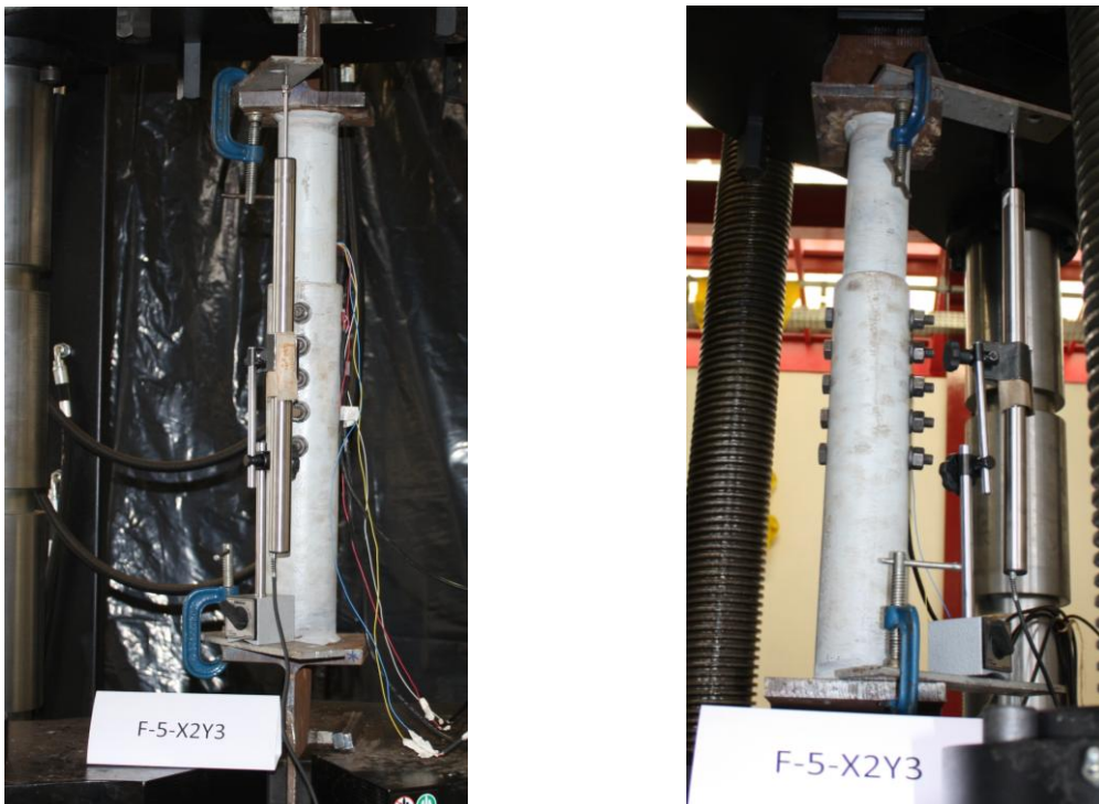
Figura 3.10.a e b – Posicionamento do LVDT no ensaio.
