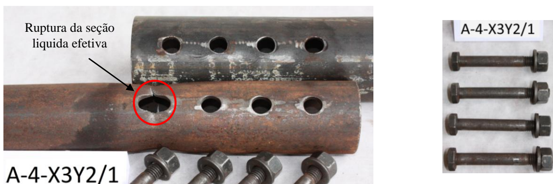
Figura 4.2 b – Protótipo A-4-X3Y2/1 após o ensaio.
