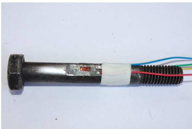
Figura 3.12 a e b – Posicionamento dos extensômetros elétricos no parafuso.
