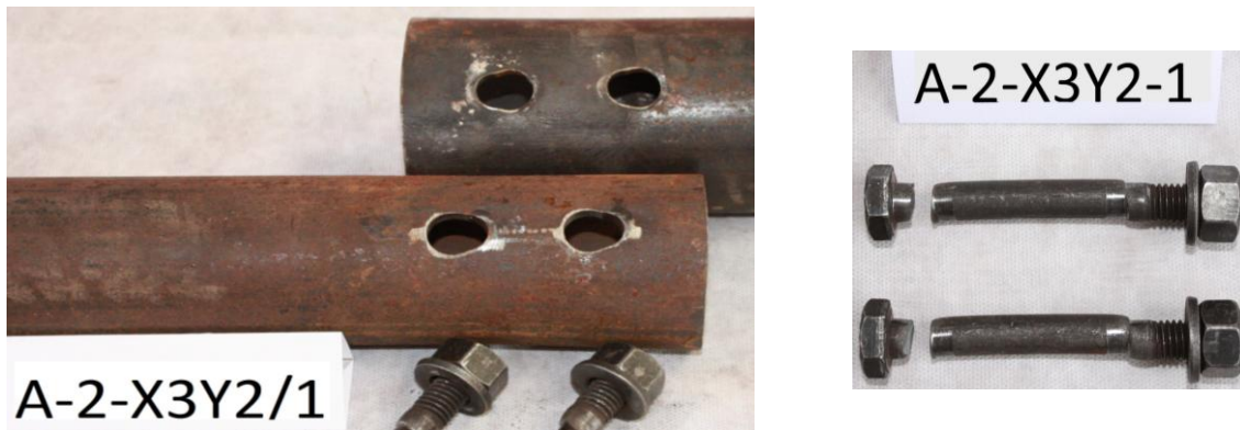
Figura 4.2 d – Protótipo A-2-X3Y2/1 após o ensaio – (Cisalhamento do parafuso)
