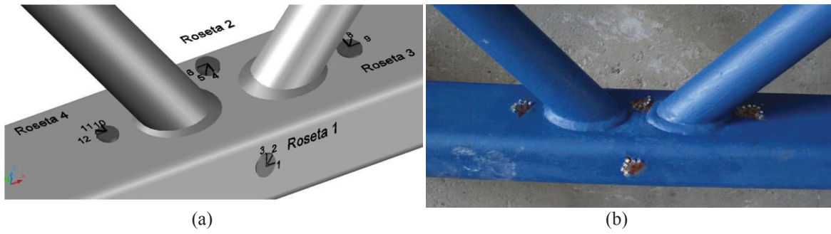
Figura 2.13 – Vista geral da posição das rosetas dos ensaios das ligações tipo “K”: (a) identificação das Rosetas; (b) Foto das rosetas coladas no protótipo de ensaio. (Mayor et al, 2012).
