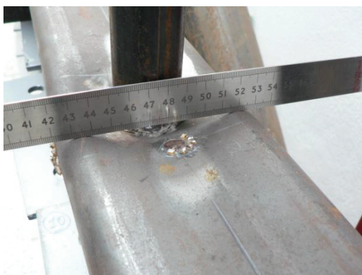
Figura 2.10 - Modo de falha obtido nos protótipos ensaiados (Nunes et al, 2011).
