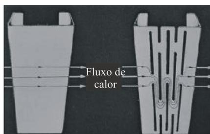
Figura 2.13 – Trajeto do fluxo de calor através das almas dos montantes.
