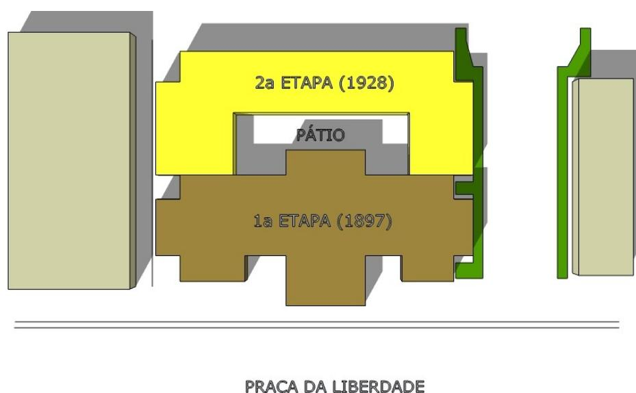
Figura 3.3 - Croqui de implantação das duas primeiras etapas construtivas do edifício.
