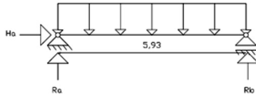
Figura 3.36: Diagrama para determinação das reações de apoio da sobrecarga nos nós das treliças dos arcos intermediários.
