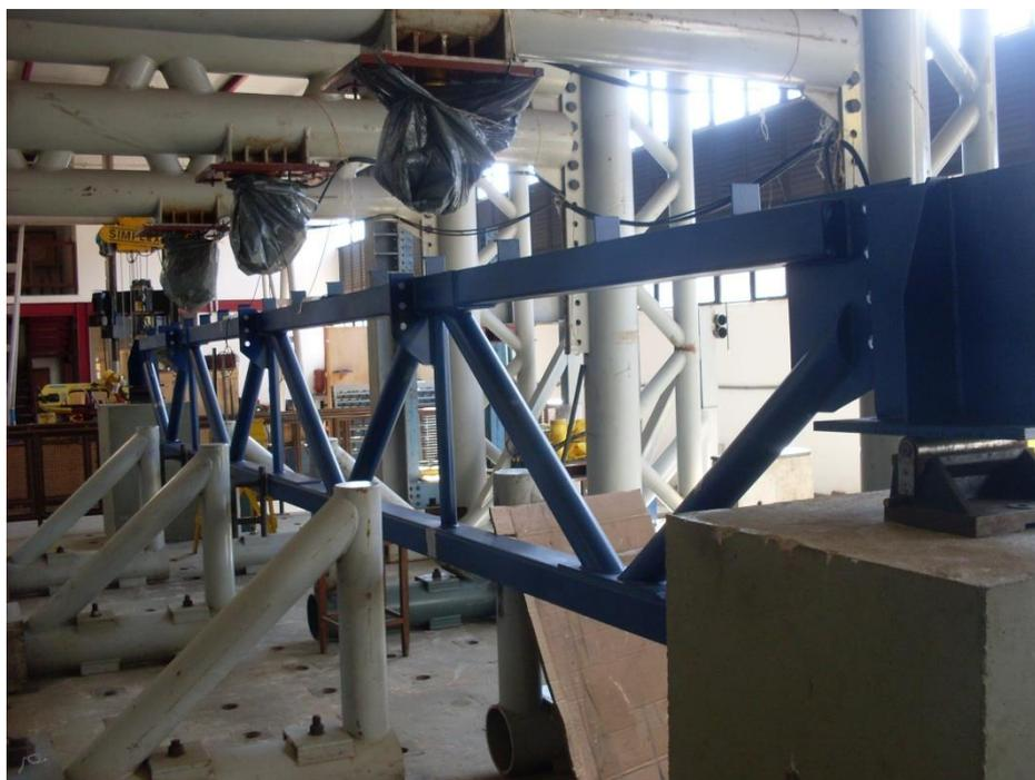
FIGURA 3.3: Viga treliçada sobre apoios no laboratório de estruturas Prof. Altamiro Tibiriçá Dias
