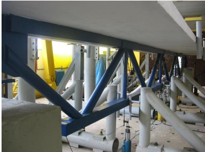
(b) Contenções laterais da viga metálica
