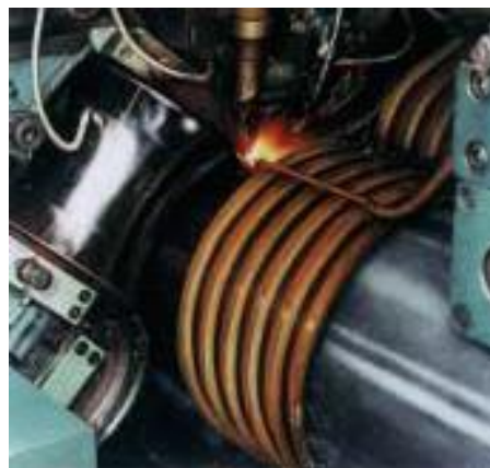
FIGURA 3.13 – Equipamento utilizado no processo de soldagem por indução de alta frequência Fonte: NUIC, 2003.
