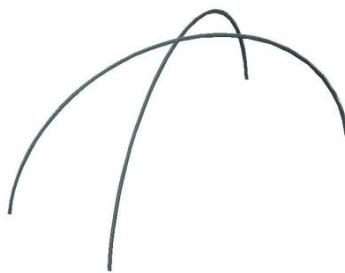
FIGURA 1.7 – Pórticos de estabilização bidirecionais
