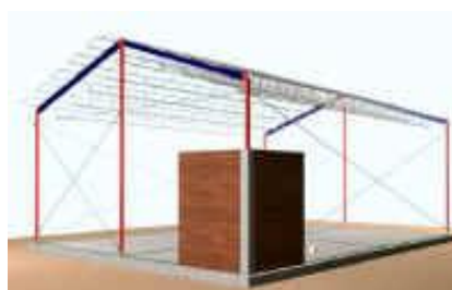
FIGURA 4.9 – Estrutura principal e vigas de cobertura Fonte: GERDAU AÇOMINAS, 2001.
