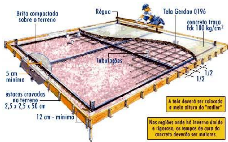
FIGURA 4.7 – Desenho esquemático da fundação radier Fonte: GERDAU AÇOMINAS, 2001.
