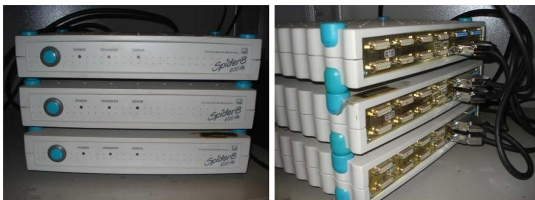
Figura 3.26 – Sistema automático de aquisição de dados "Spider 8".
