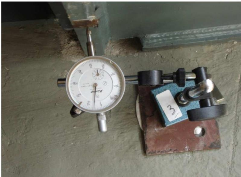
**Figura 3.19 – Defletômetro de haste com mostrador analógico.**
