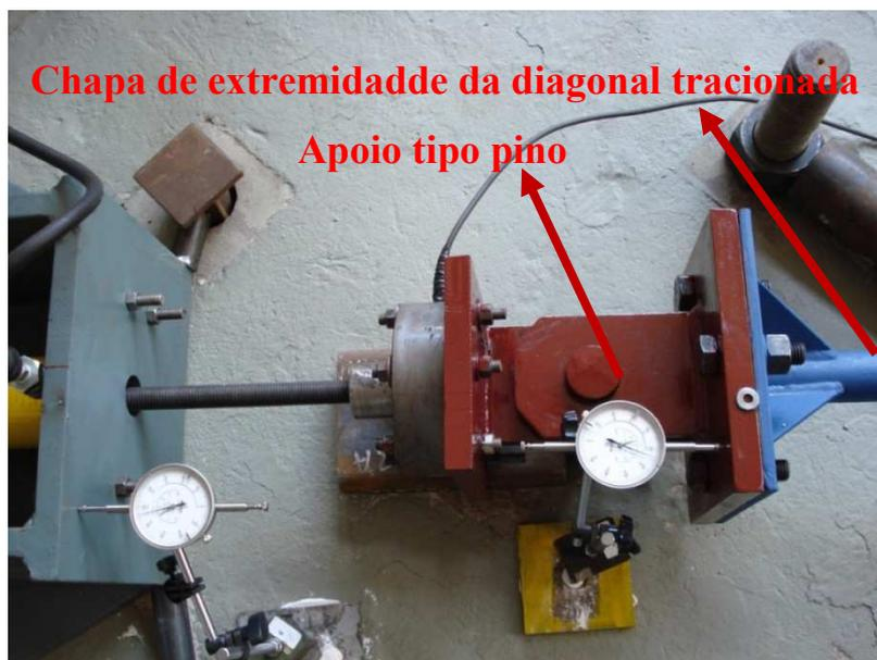
Figura 3.13 - Chapa de extremidade e sistema rotulado para a aplicação de tração às diagonais.
