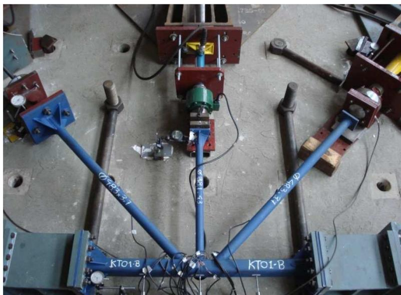
**Figura 3.3 – Esquema de montagem da ligação “KT”.**
