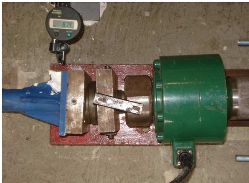
Figura 3.10 - Rótula universal e chapa de distribuição uniforme no montante após o primeiro ensaio "KT01-B".
