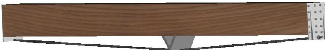
Figura 3.51 - Reforço de viga de madeira com chapas de topo, cantoneira e tirantes.
