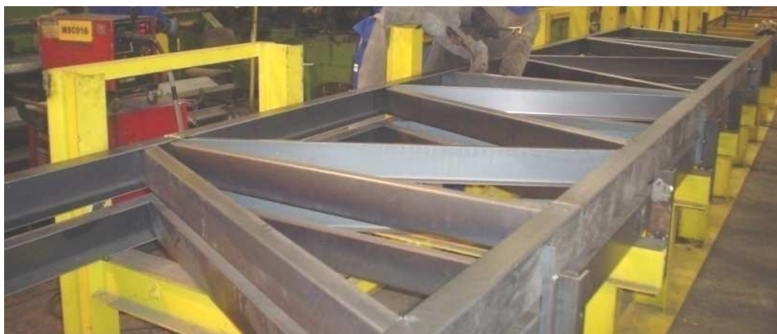
Figura 3.11 - Bancada de gabarito para produção de treliças (Fonte: álbum do autor).
