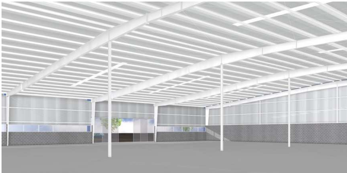
Figura 1.3 - Galpão formado por pórticos de perfis de alma cheia.
