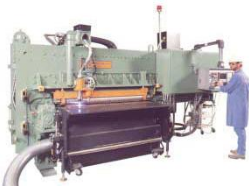
Figura 3.10 – Máquina CNC de corte a plasma, Peddinghaus.. Fonte: Raad Jr (1999).
