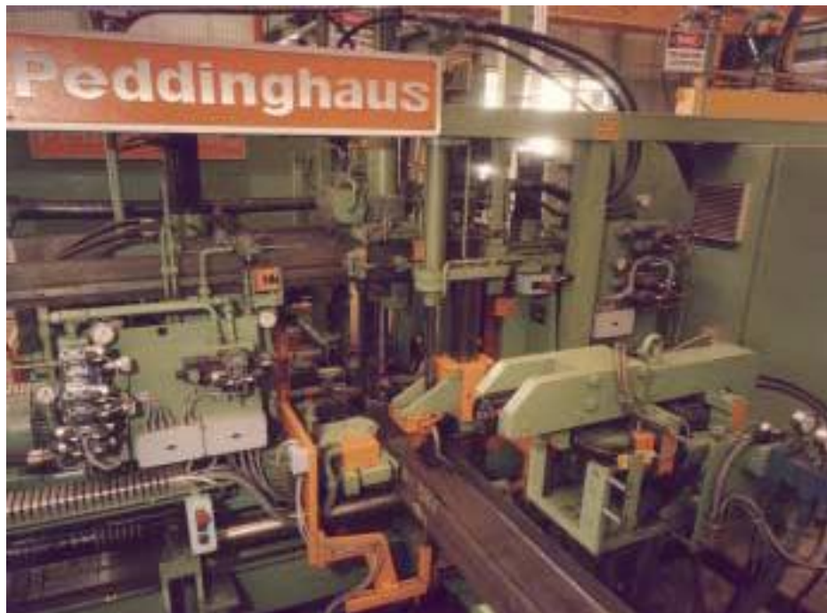
Figura 3.13 - Máquina CNC para preparação de perfis. Fonte: Raad Jr (1999)
