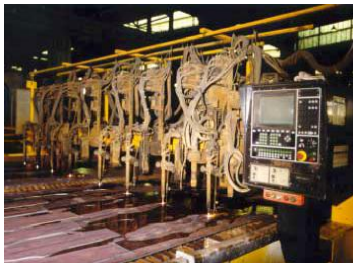
Figura 3.9 – Máquina CNC de corte térmico – Flame-planner. Fonte: Raad Jr (1999).
