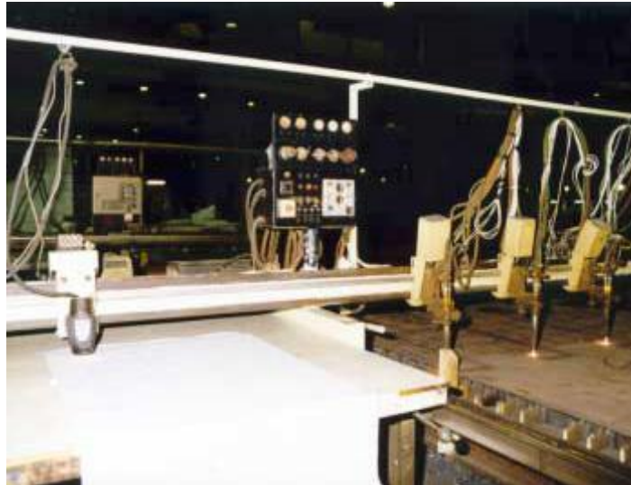
Figura 3.8 – Máquina automática de corte térmico, fotocopiadora. Fonte: Raad Jr (1999).
