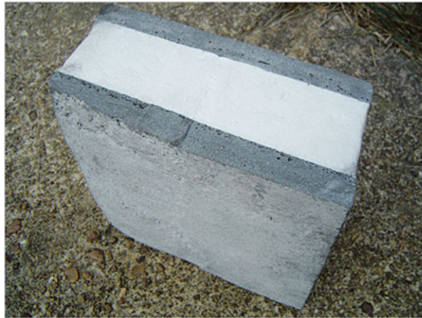
Figura 1.1 Grancrete – Associação concreto – isopor. Fonte: sodesign.blogspot.com.br
