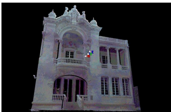
Figura 24: Exemplo de imagem capturada por scanner – nuvem de pontos.
