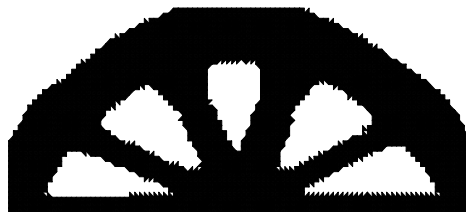
Figura 5.7 - RR= 5,5\% , RRI=1\% , ER=1,1\% , VRI=5\% , 7680 elementos triangulares, Iteração 69 - malha (96x40) - SESO
