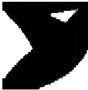
Figura 4.6.7-RR=2%,RRI=1%,ER=1%,VI=72%, VRI=5%, 8000 elementos triangulares, Iteração 32 - malha (80 \times 40) - SESO.
