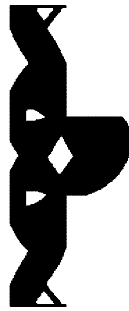
Figura 5.6.43 – RR=3\% , RRI=1\% , ER=0,5\% , VRI=1,75\% , 22656 elementos triangulares, Iteração 102 – malha (88x216) – SESO
