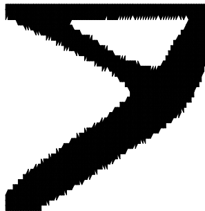
Figura 4.6.8-RR=3%,RRI=1%,ER=1%,VI=40%, VRI=5%, 8000 elementos triangulares, Iteração 88 - malha (80 \times 40) – SESO
