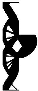
Figura 5.6.44 – RR=4\% , RRI=1\% , ER=0,5\% , VRI=1,75\% , 22656 elementos triangulares, Iteração 178 – malha (88x216) – SESO
