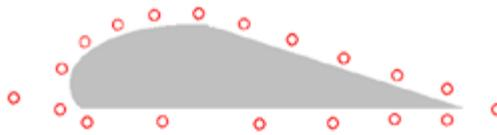
*Figura 3.1 – Fluido (elementos vermelhos) com uma maior velocidade na parte superior da asa, faz com que sua pressão diminua, provocando o voo da aeronave*
