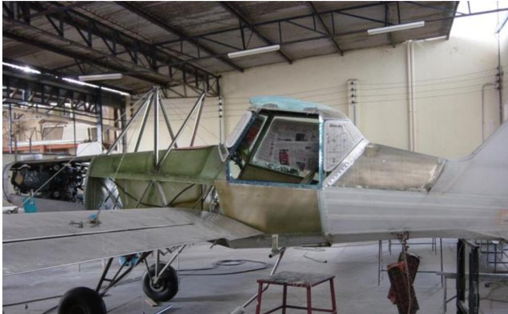
*Figura 4.2 – Montagem fuselagem Falcão AG-21(Fonte: FABE)*
