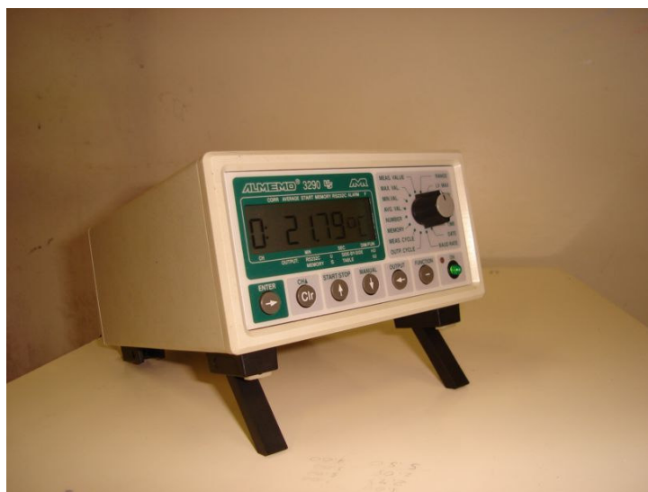
Figura 3.2 – Data Logger ALMEMO 3290-8.
