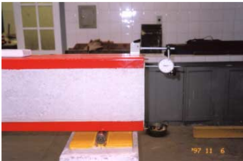
Foto 4.6 – Medição de Deslizamento do Concreto
