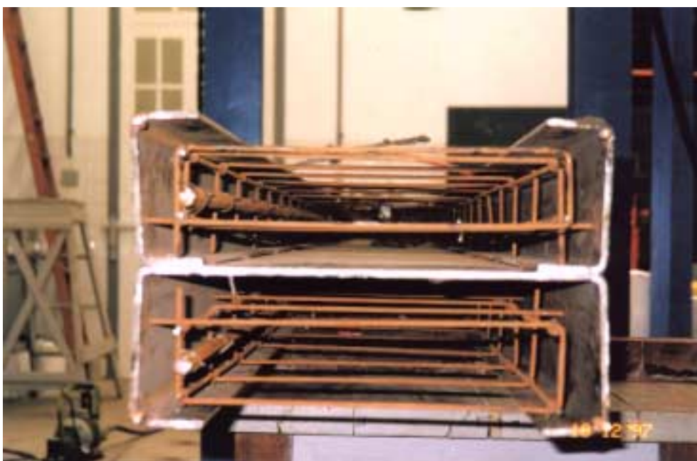
Foto 4.2 - Ilustração da Viga VS2 (perfil de aço com armaduras)
