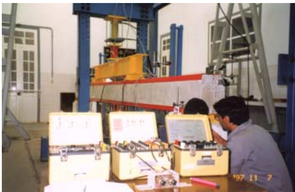
Foto 4.4 – Aquisição dos Valores de Deformação
