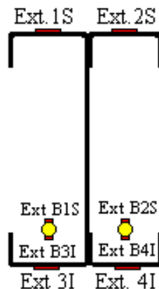
Figura 4.12 - Disposição dos Extensômetros no Perfil e nas Barras de Armadura
