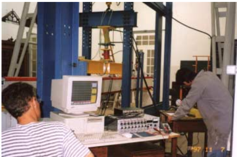
Foto 4.3 – Aquisição dos Valores das Cargas e Deslocamentos
