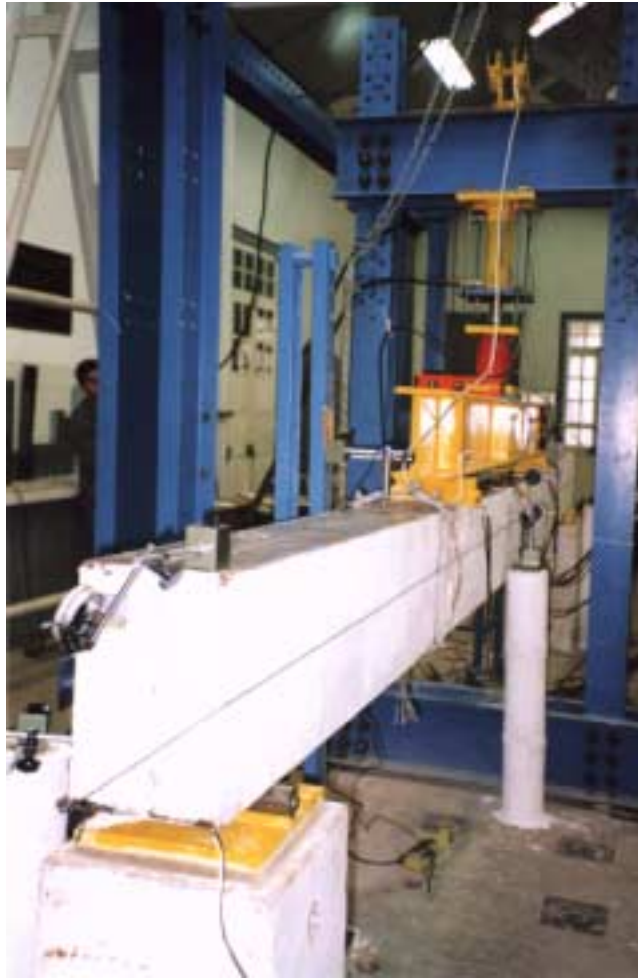
Foto 5.8 - Vista Geral da Viga VS1 Deformada
