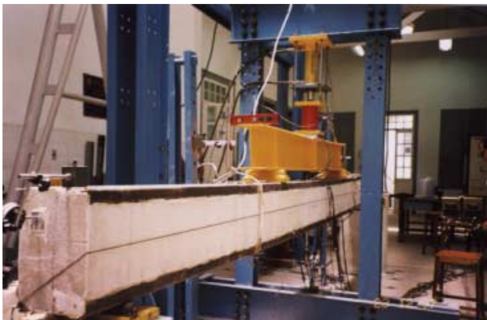
Foto 5.5 - Vista Geral da Viga VD2 Deformada
