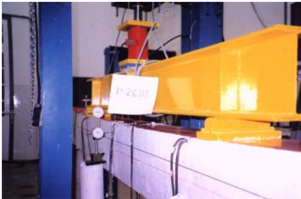
Foto 5.10 - Flambagem Local da Mesa Comprimida do Perfil
