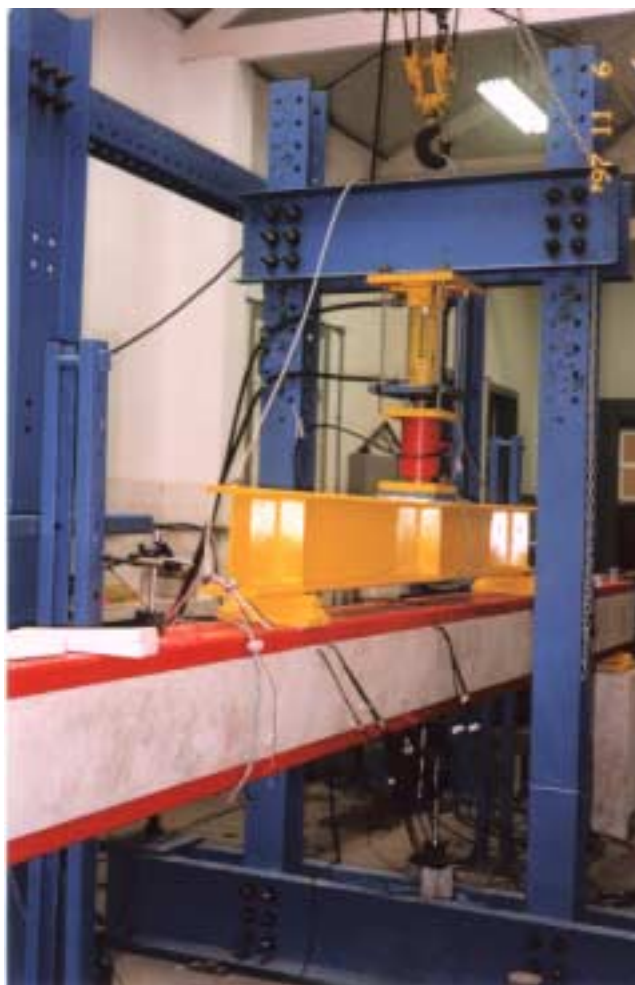
Foto 4.5 – Vista Geral do Sistema de Aplicação de Carga
