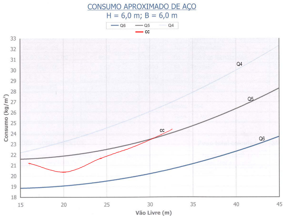
Figura 5.30 – Comparativo do consumo de aço para galpão em pórtico de alma cheia.
