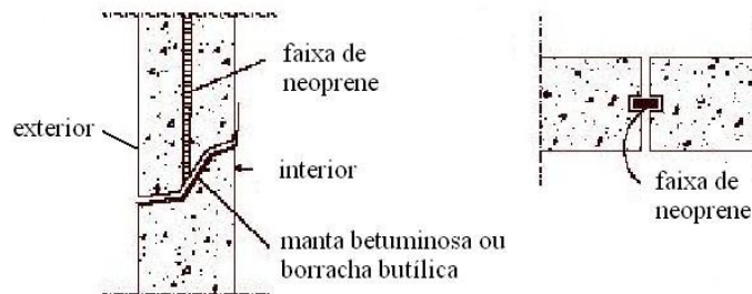
Figura 4.14 – Esquema de proteção de junta aberta entre painéis de concreto em corte e em planta Fonte: COSTA, 2004
