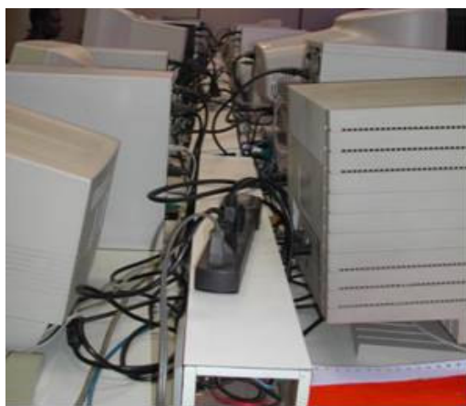
Figura 5.51 – Emaranhado de fiação
