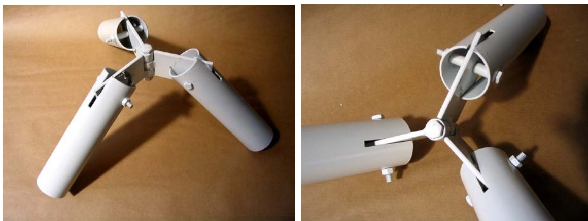
Figs.115 e 116. Fotografia do protótipo do Nó Tri-Ortogonal de três folhas Fonte: Imagem produzida pelo autor, 2006.
