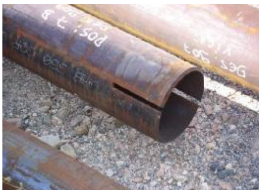
Figura 5.27: Rasgo na extremidade da peça para ligação com chapa de gusset. Montagem da estrutura na empresa Brafer. Fonte: Arquivo pessoal, 2005.
