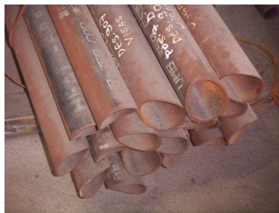
(b) Tubos das diagonais da Viga Principal.
