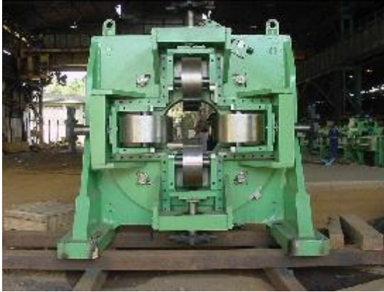
Figura 5.8: Quadradora de tubos V&M do Brasil, Belo Horizonte – MG. Fonte: GERKEN, 2003.
