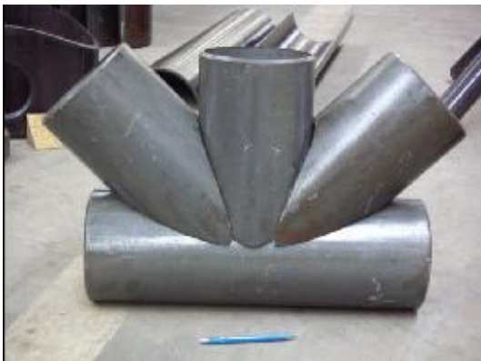
Figura 5.6: Ligação direta entre tubos através do corte “boca de lobo”, Fábrica Açotubo - SP. Fonte: Arquivo pessoal, 2005.
