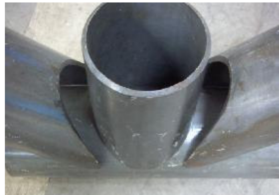
Figura 5.6: Ligação direta entre tubos através do corte “boca de lobo”, Fábrica Açotubo - SP. Fonte: Arquivo pessoal, 2005.
