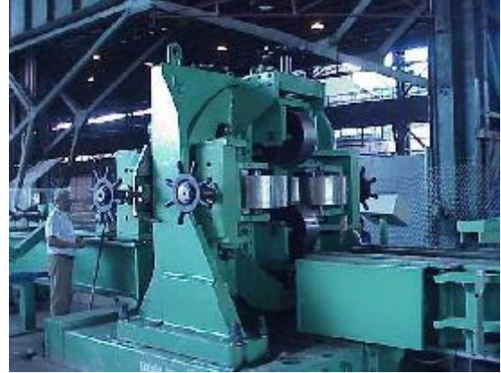
Figura 5.9: Sistema perfilador cabeça turca V&M do Brasil, Belo Horizonte - MG. Fonte: GERKEN, 2003.
