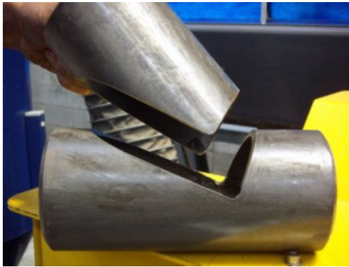
(a) Corte encaixe “boca-de-lobo” bisel 45° sela
