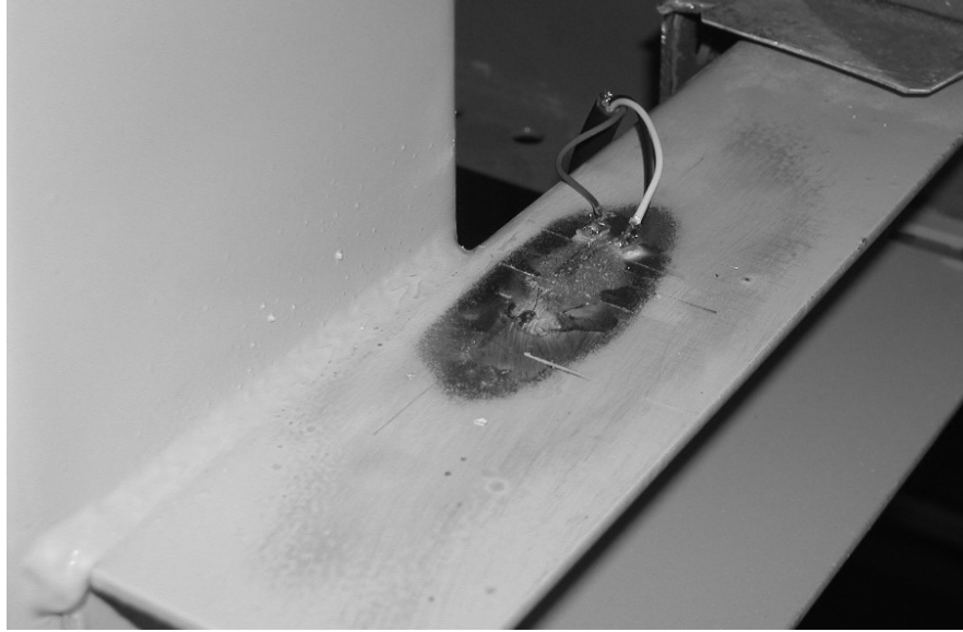
Figura 5.28. Extensômetro instalado no braço.
