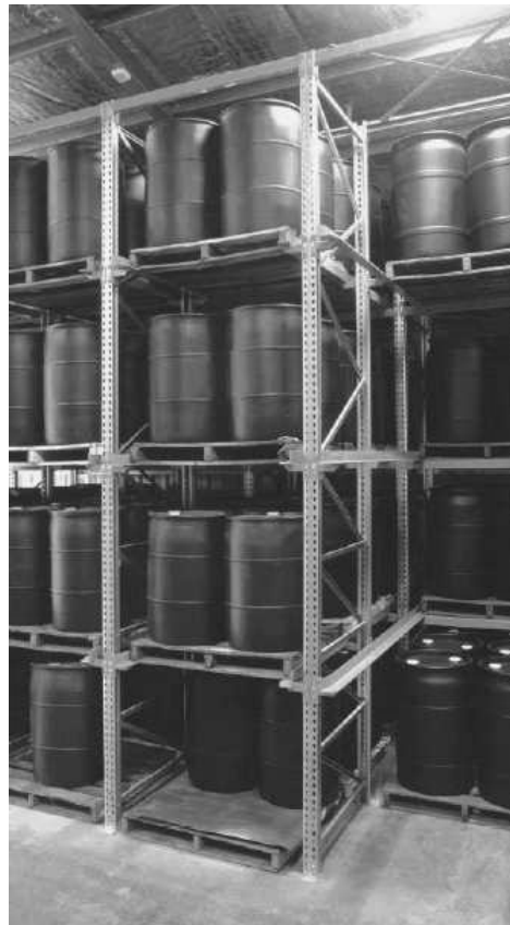
Figura 1.5. Modelo Drive-in em operação (Brownbuilt (2004)).
