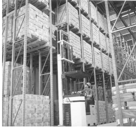
Figura 1.4. Modelo Drive-in em operação (Águia (1999)).
