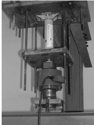
Figura 5.15. Montagem do Cilindro Hidráulico 2
