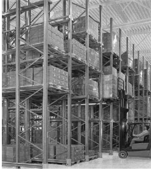
Figura 1.6. Modelo Drive-in em operação (Dexion (2004)).
