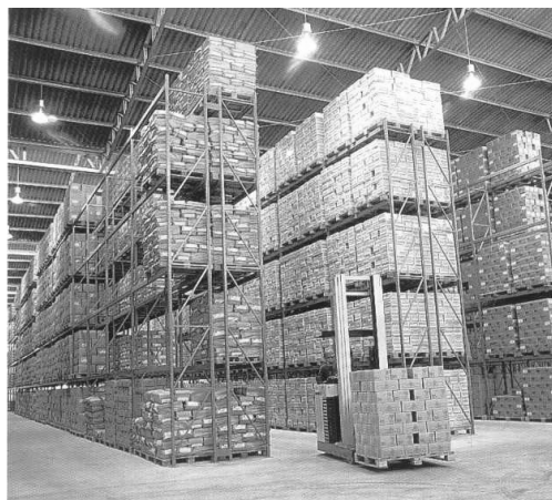
Figura 1.2. Sistemas de armazenamento do tipo porta paletes (Águia (1999))
