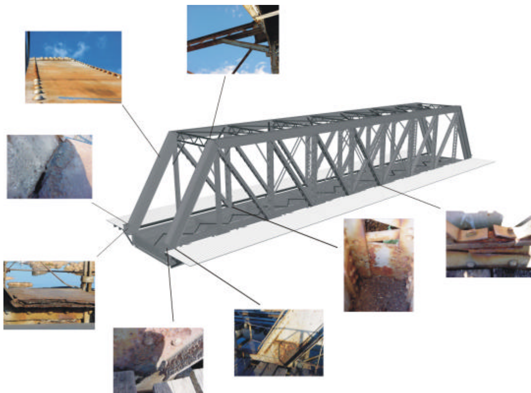
Figura 6.5 – Detalhamento de pontos de deterioração nas Pontes 1 e 2; vista 1.
