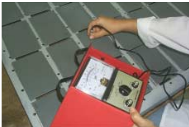
Figura 5.28 – Medição de espessura da película de tinta seca.
