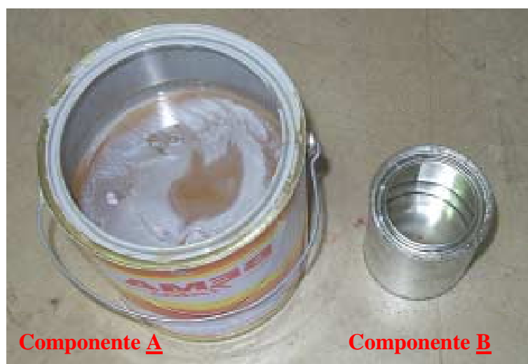
Figura 4.10 – Componentes A (pigmento: tintoriais) e B (resina: poliéster – acrílico – isocianato alifático) do esmalte poliuretano alifático.
