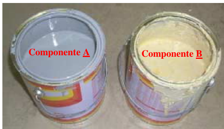
Figura 4.9 – Componentes A (pigmento: tintoriais e inertes) e B (resina: epóxi modificado – poliamida) do mastic epóxi-amida econômico.
