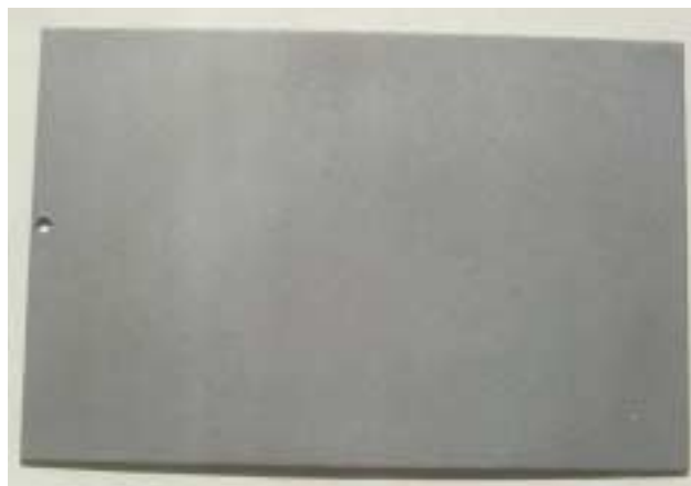
Figura 5.26 – Corpo-de-prova após jateamento abrasivo - padrão Sa2 ½, conforme a norma sueca SIS 05 5900 – 1967.
