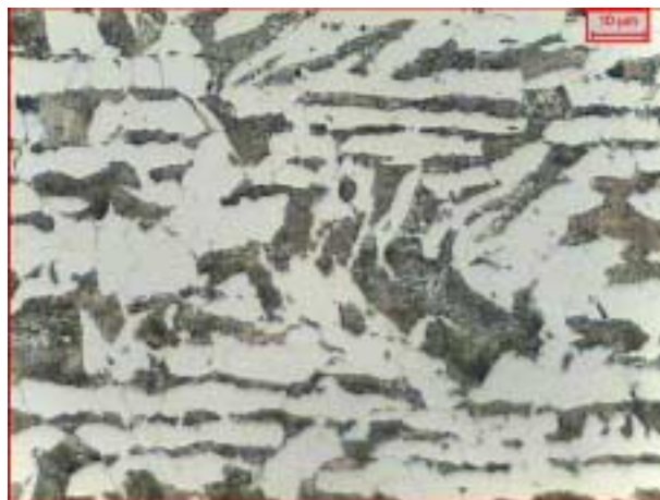
Figura 5.13 – Fotomicrografia de aço do tipo AISI 1123; amostra 2; ataque com Nital 2%; aumento de 1000X; ferrita (claro) e perlita (escuro).
