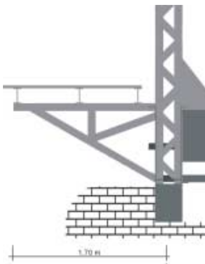
Figura 5.9 – Representação esquemática do detalhe do passeio lateral da PMH.
