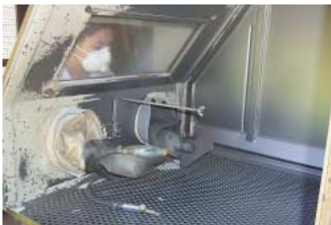
Figura 5.25 – Conjunto para jateamento abrasivo das superfícies das amostras.
