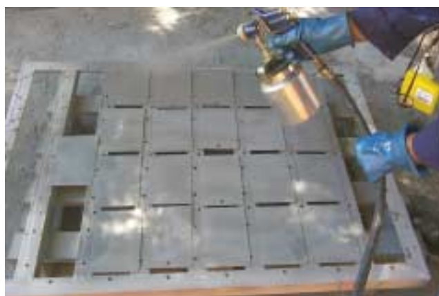
Figura 5.27 – Pintura dos CPs com pistola convencional com o recipiente acoplado diretamente à pistola.
