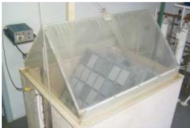
Figura 5.31 – Câmara de névoa salina com as bandejas durante os ensaios.
