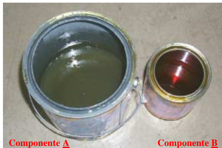
Figura 4.7 – Componentes A (pigmento: pó de zinco e cargas especiais) e B (resina: epóxi - poliamida) do primer epóxi amida rico em zinco.
