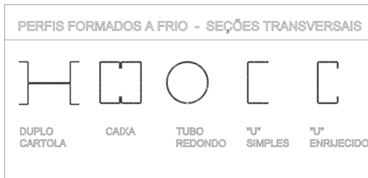
Figura 2.3: Seções transversais de perfis formados a frio. Fonte: Arquivo do Autor
