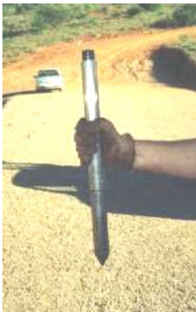
Figura 4.2 – Detalhe da sonda cone penetrométrica utilizada
