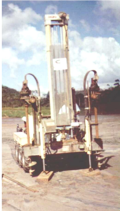
Figura 4.1 – Penetrômetro utilizado nos ensaios de piezocone
