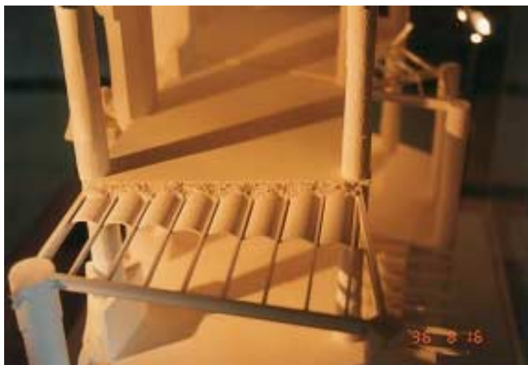
FIGURA 5.32 – Maquete do esquema estrutural do piso da Casa Milá (La Pedrera)
