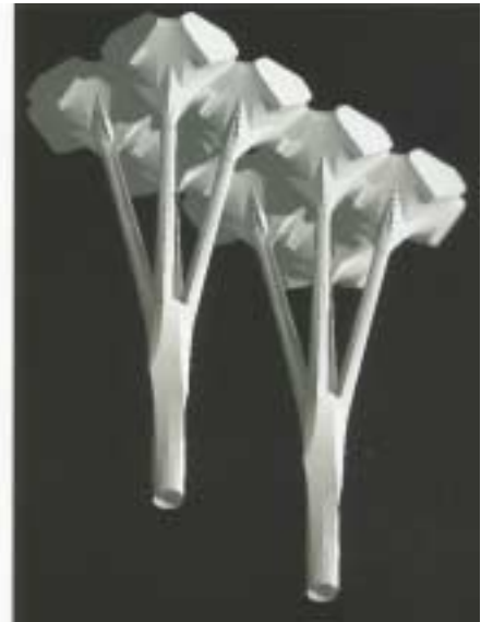
FIGURA 5.36 – Desenho em CAD das etapas para finalização dos pilares indicados na FIG. 5.34 FONTE - GÓMEZ, 1996. p.135,156.
