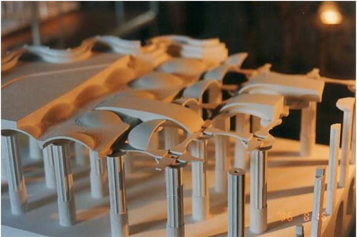
FIGURA 5.28 – Maquete do esquema estrutural do terraço/cobertura do Parque Güell
