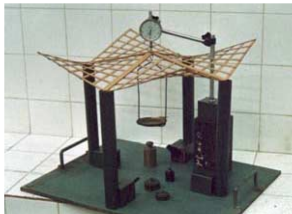
FIGURA 4.41 – Montagem do Modelo HP FONTE - Arquivo pessoal.
