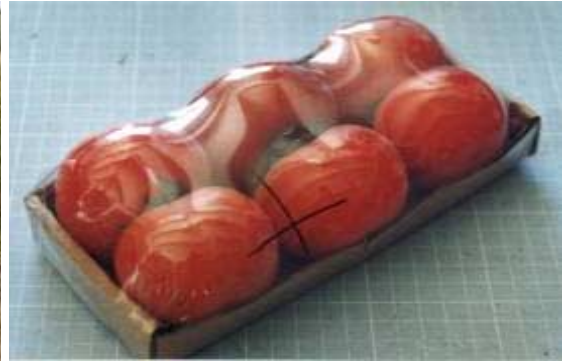
FIGURA 7.25 – Estado de equilíbrio do filme de PVC com a presença da dupla curvatura indicada a caneta FONTE - Arquivo pessoal.
