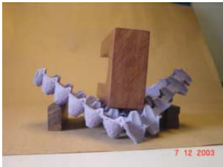
FIGURA 9.8 – Flexão provocada pela adição de uma carga FONTE - Arquivo pessoal.
