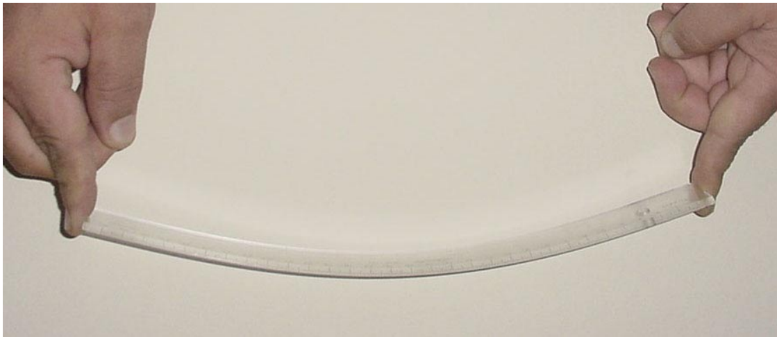
FIGURA 3.11 - Perda de estabilidade de uma barra reta solicitada a compressão FONTE – Arquivo pessoal, 2003.
