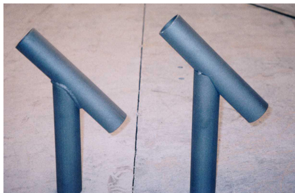
FIGURA 5.10 - Ligação de dois tubos de seção transversal circular executada com dois cortes planos FONTE – ARAÚJO, 2001.
