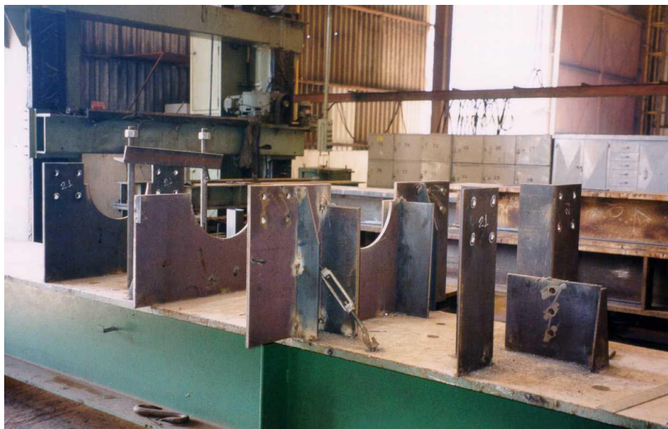
FIGURA 5.2 - Galpão AçoTubo: gabarito de fabricação de pilares tubulares de seção circular FONTE – ARAÚJO, 2001.
