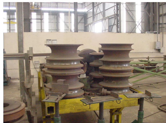
FIGURA 5.29 - Calandra de tubos: (a) máquina para calandragem; (b) rolos de calandragem FONTE – Arquivo pessoal, 2002.
