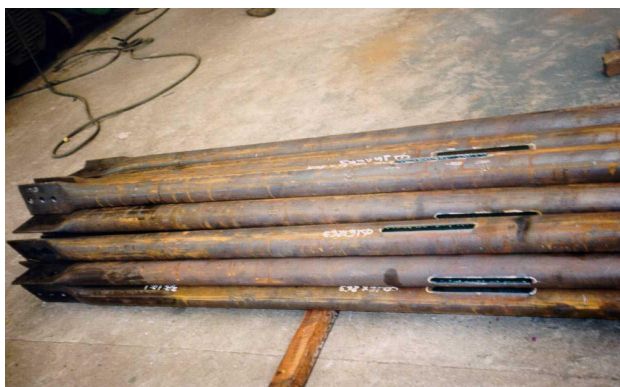
FIGURA 5.17 - Rasgos executados no meio do tubo para ligação com chapa plana
