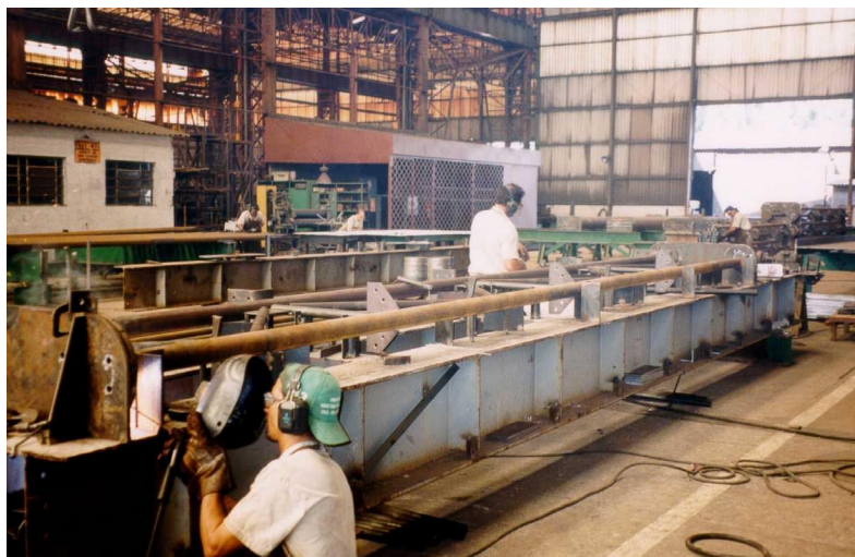
FIGURA 5.3 - Galpão AçoTubo: bancada gabarito para fabricação de tesouras treliçadas tubulares FONTE – ARAÚJO, 2001.
