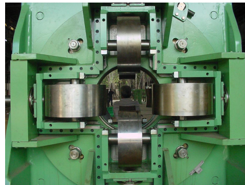
FIGURA 3.5 - Quadradora de tubos – VMB, Belo Horizonte-MG FONTE – Arquivo pessoal, 2002.
