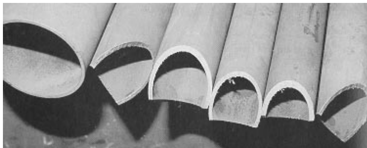
FIGURA 5.8 - Corte em “boca de lobo” FONTE – ARAÚJO, 2003.
