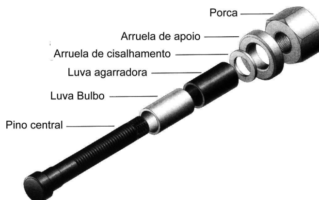
FIGURA 5.40 - Vista explodida do prendedor Huck Ultra-Twist FONTE – CIDECT, 1998.
