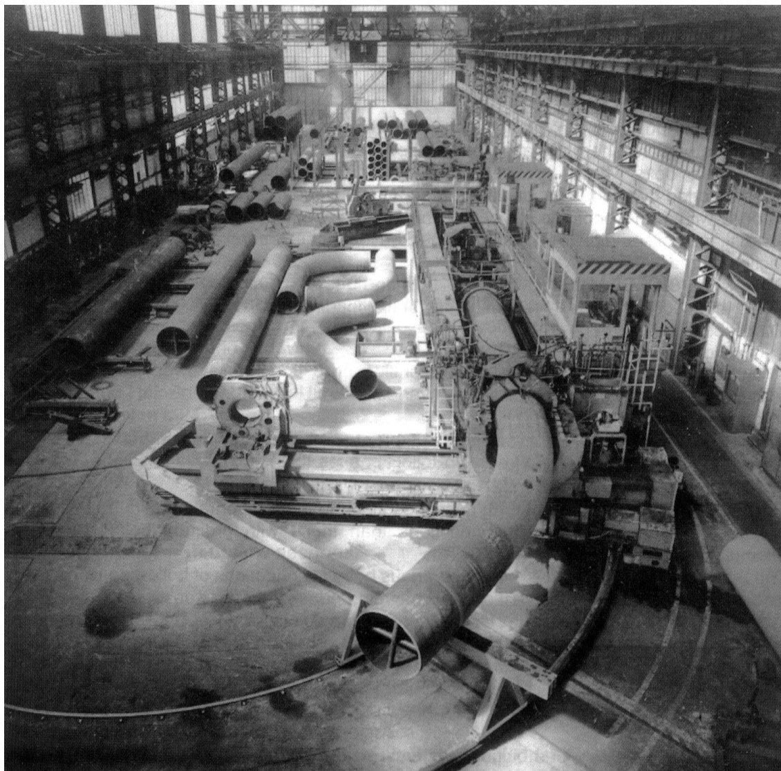
FIGURA 5.33 - Dobramento por indução FONTE – CIDECT, 1998.
