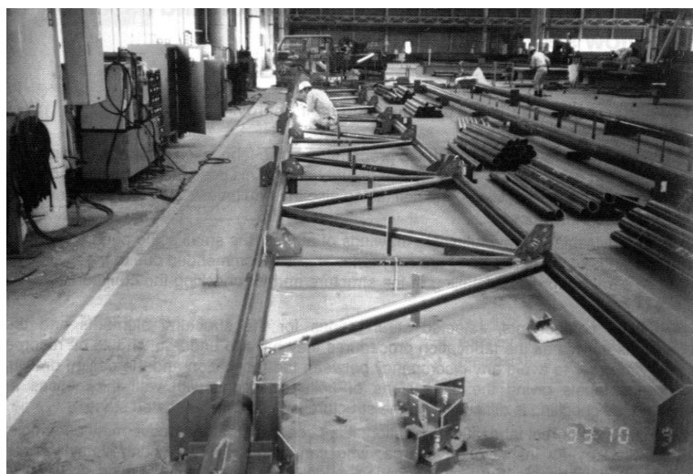
FIGURA 5.4 - Gabarito para uma viga treliçada do tipo Warren FONTE – CIDECT, 1998.
