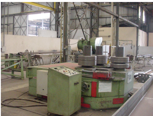
FIGURA 5.29 - Calandra de tubos: (a) máquina para calandragem; (b) rolos de calandragem FONTE – Arquivo pessoal, 2002.
