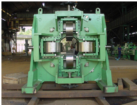
FIGURA 3.5 - Quadradora de tubos – VMB, Belo Horizonte-MG FONTE – Arquivo pessoal, 2002.
