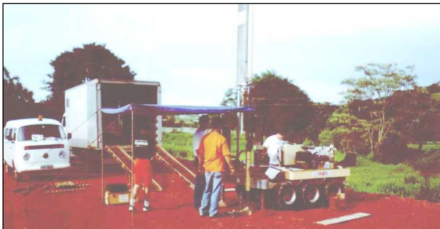
Foto 12– Execução dos ensaios CPTU e Vane Test sobre a plataforma da berma
