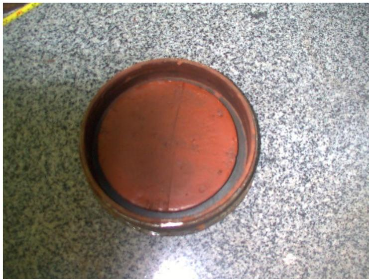
Figura 3.9: Final do ensaio de contração livre
