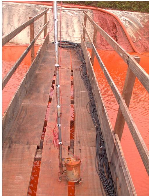
Figura 3.40: Amostrador de caneco
