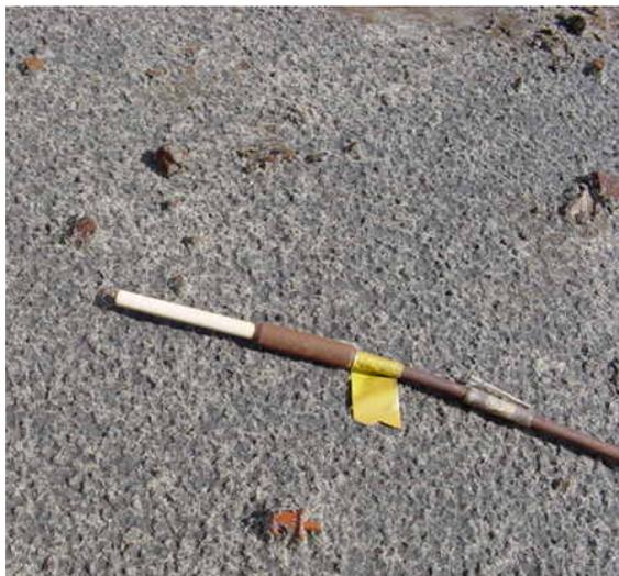
Figura 3.26: Sensor de temperatura
