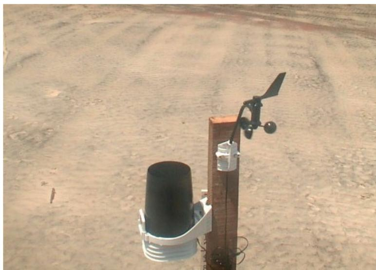
Figura 3.20: Estação meteorológica
