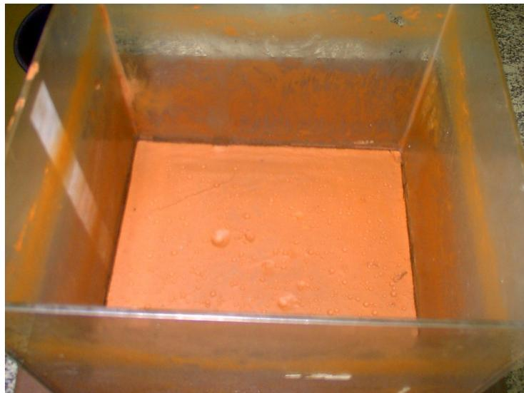
Figura 3.3: Ensaio no laboratório e amostra com algumas trincas superficiais
