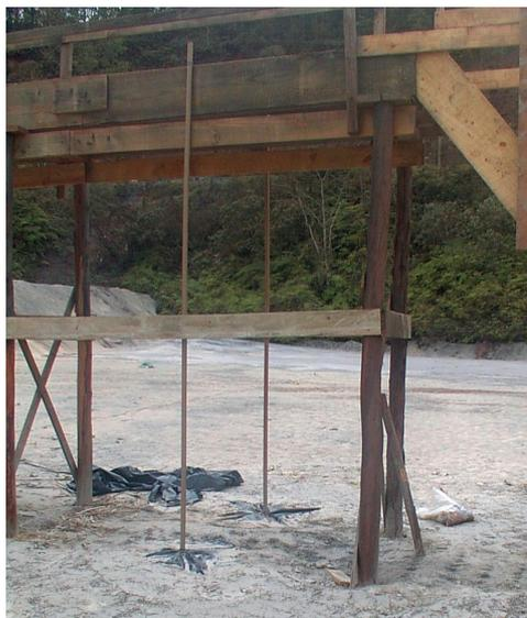
Figura 3.30: Vista dos dois piezômetros instalados
