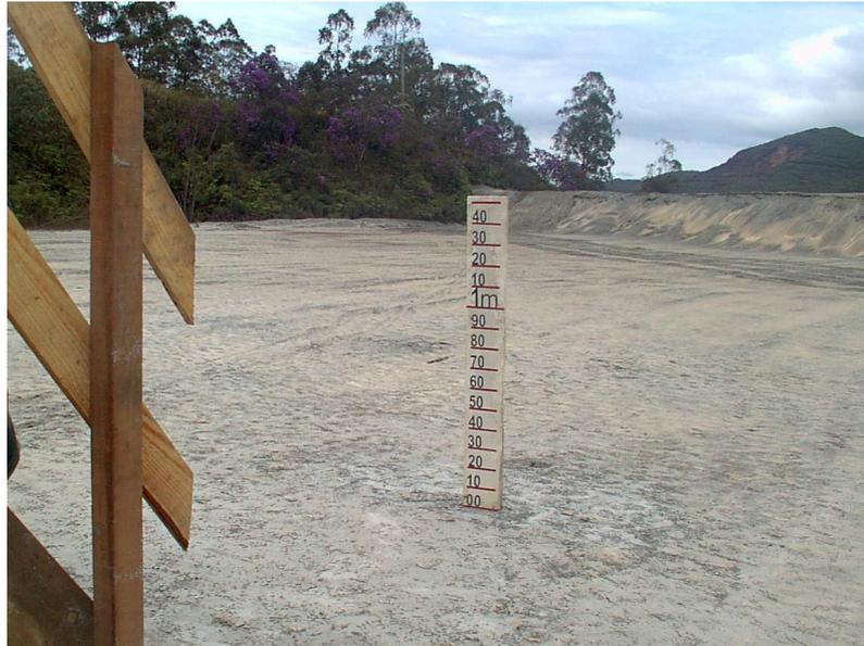
Figura 3.29: Régua graduada para medir o recalque
