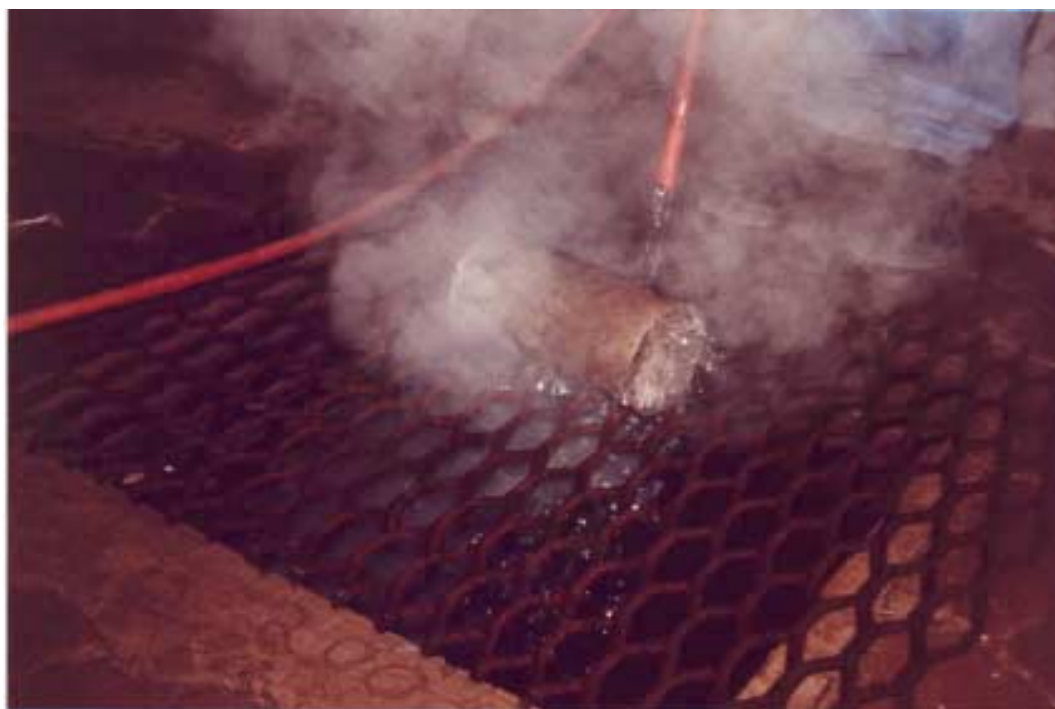
Figura 25 – Resfriamento brusco dos corpos de prova
