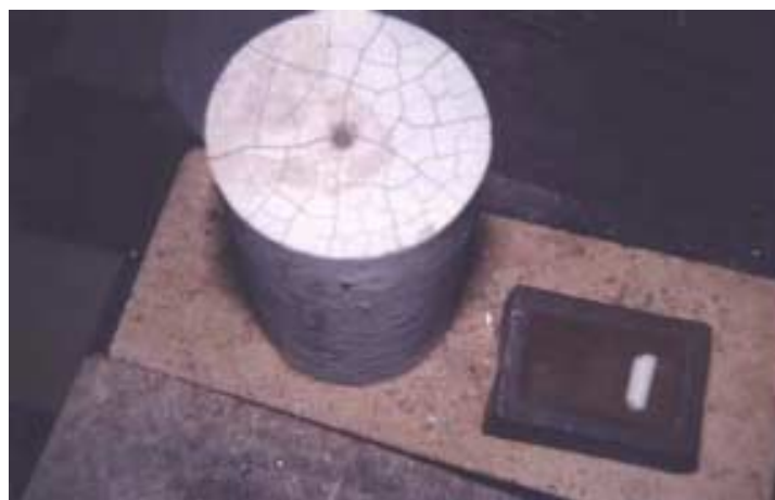
Figura 51 – Corpo de prova furado para monitorar aquecimento
