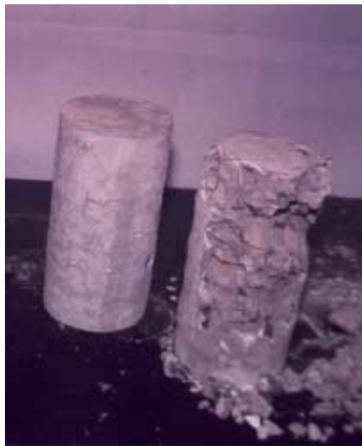
Figura 52 – Corpos de prova deteriorados por calor
