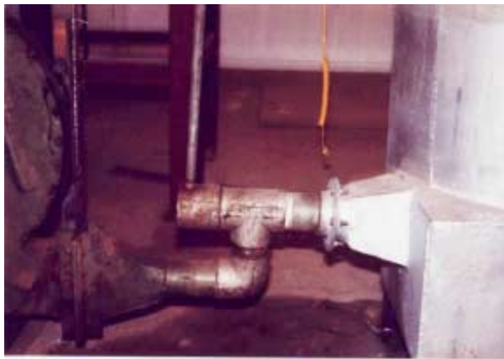
Figura 8 – Bico atomizador do forno
