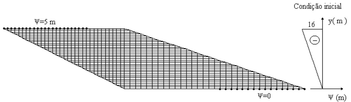
Figura 5.18 – Processo de fluxo em uma pilha de rejeito – malha de elementos finitos.
