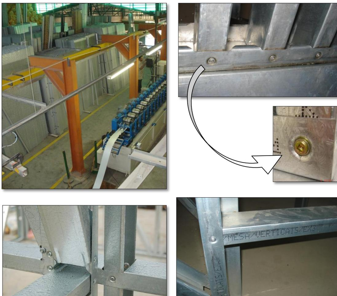
**Figura G1-** Perfiladeira / Detalhes do encaixe dos parafusos/ Etiketamento do perfil.
