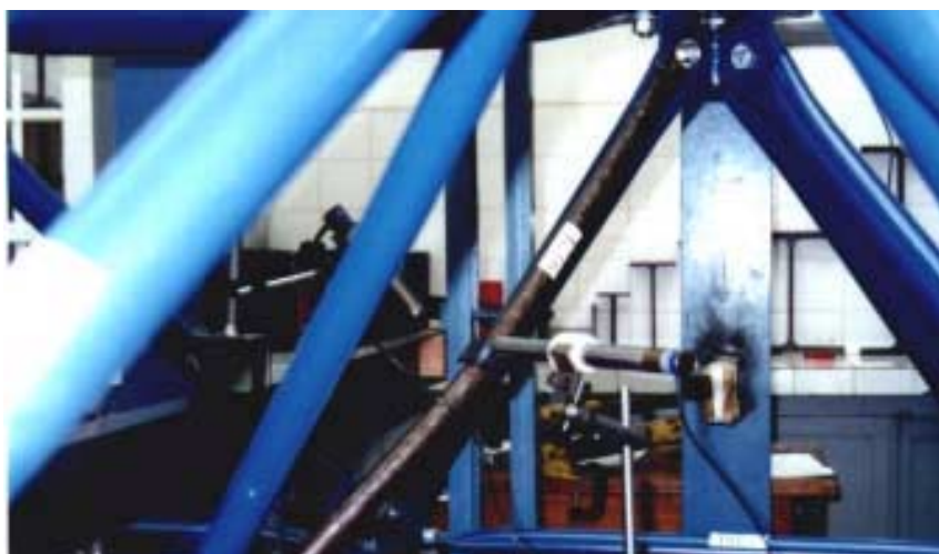
Foto V.11 - Modo de flambagem da barra 9-12, no ensaio 912F.
