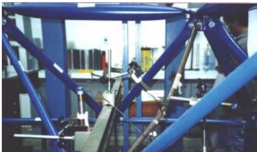
Foto V.15 - Modo de flambagem da barra 9-12. Ensaio 912H.
