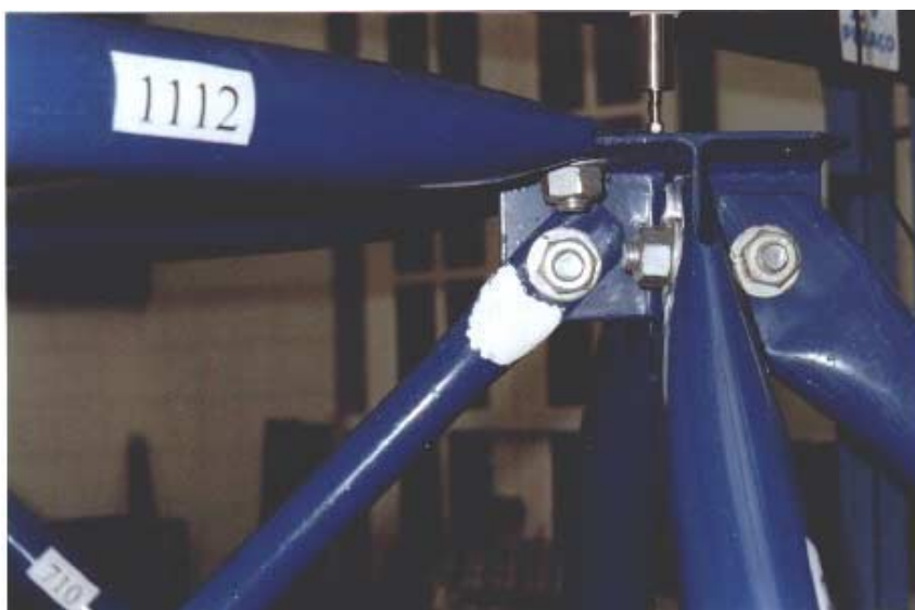
Foto IV.2 – Detalhe do nó fora dos apoios.
