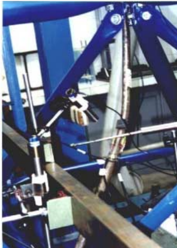
Foto V.13 - Modo de flambagem da barra 9-12, no ensaio 912G.
