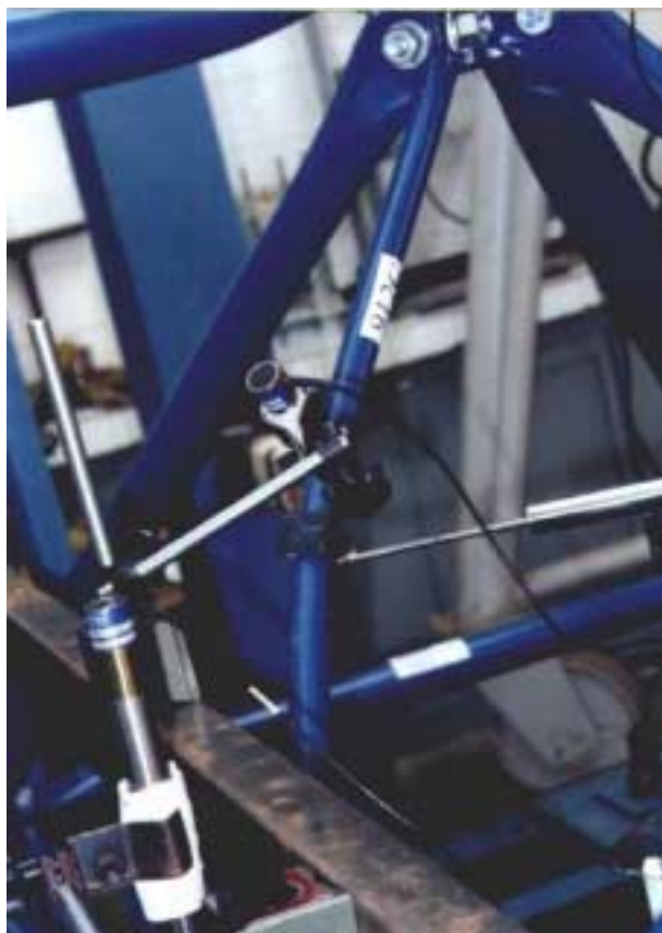
Foto V.9 - Modo de flambagem da barra 9-12 segundo a direção horizontal no ensaio 912C.
