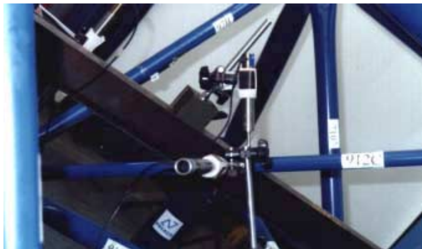
Foto V.8 - Modo de flambagem da barra 9-12 segundo a direção vertical no ensaio 912C.
