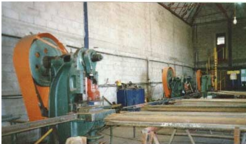
Foto II.5 – Detalhe da prensa de amassamento, utilizada na confecção das barras- Preaço- BH/MG.
