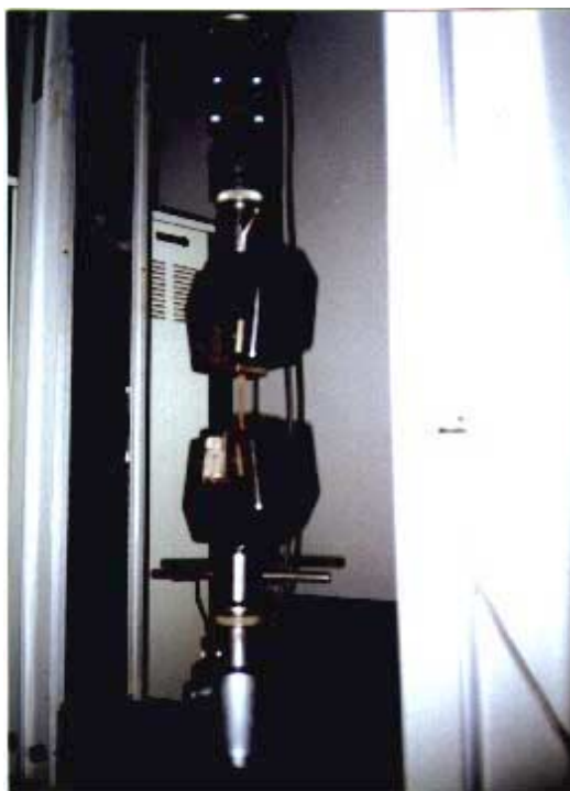
Foto IV.19 – Vista geral da máquina universal de tração durante os ensaios.
