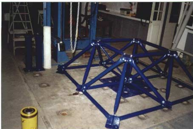
Foto IV.14 – Vista do módulo de ensaio montado, antes do içamento.
