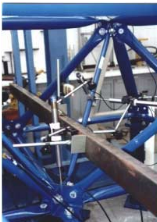
Foto V.5 - Instrumentação da barra 9-12 no ensaio 912B.
