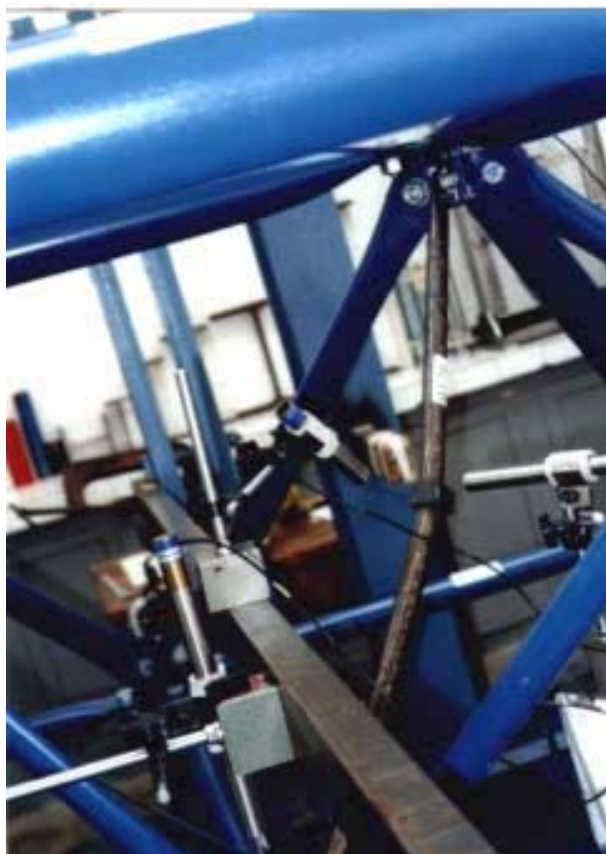
Foto V.12 - Modo de flambagem da barra 9-12, no ensaio 912F.
