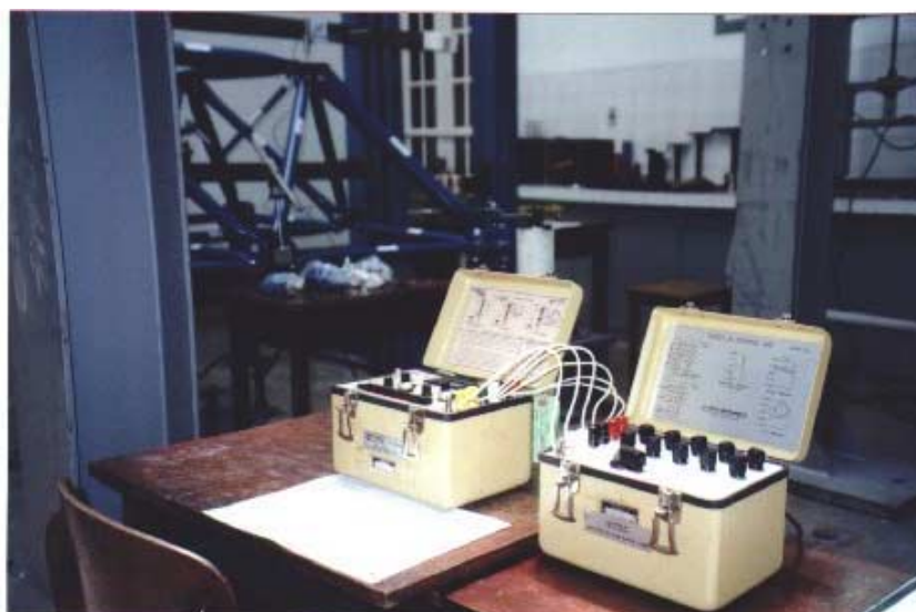
Foto IV.10 - Detalhes do sistema de leitura dos extensômetros elétricos.
