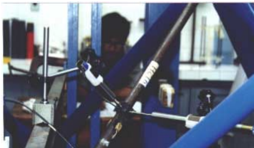
Foto V.14 - Modo de flambagem da barra 9-12, no ensaio 912H.
