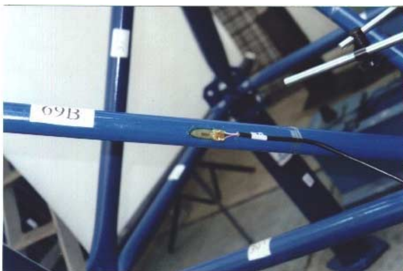
Foto IV.12 - Detalhe da extensometria.
