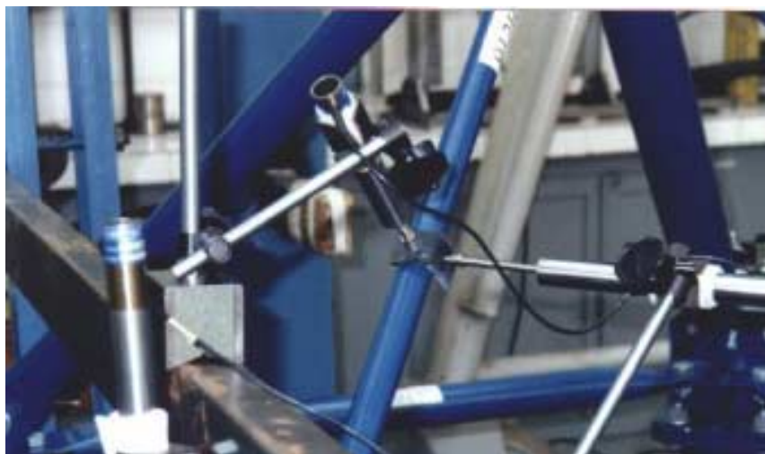
Foto V.6 - Instrumentação da barra 9-12 no ensaio 912B.
