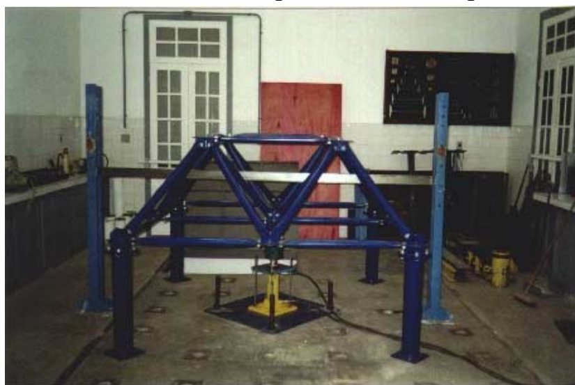
Foto IV.18 – Vista geral do módulo posicionado sobre os apoios e sistema de carga instalado.
