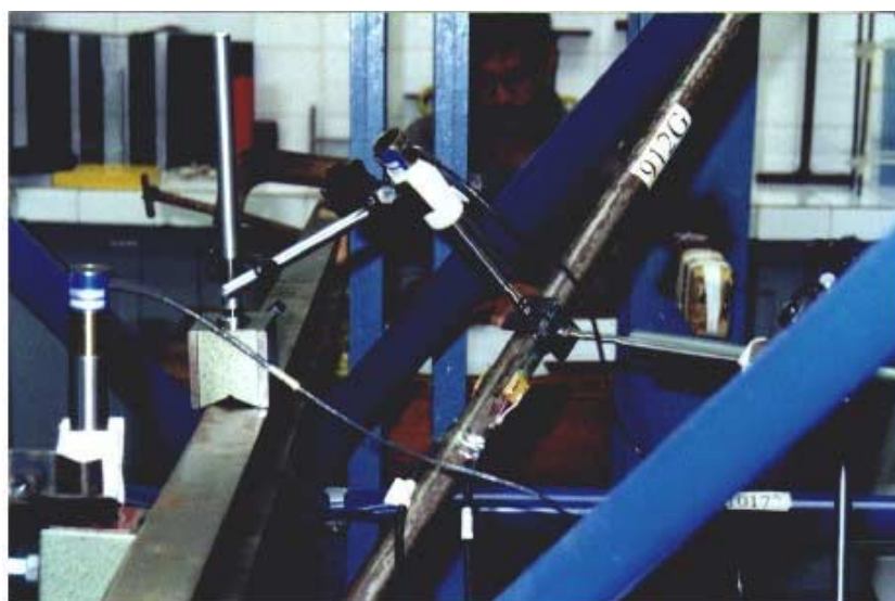
Foto IV.9 - Detalhe da instrumentação da barra fragilizada 912G.
