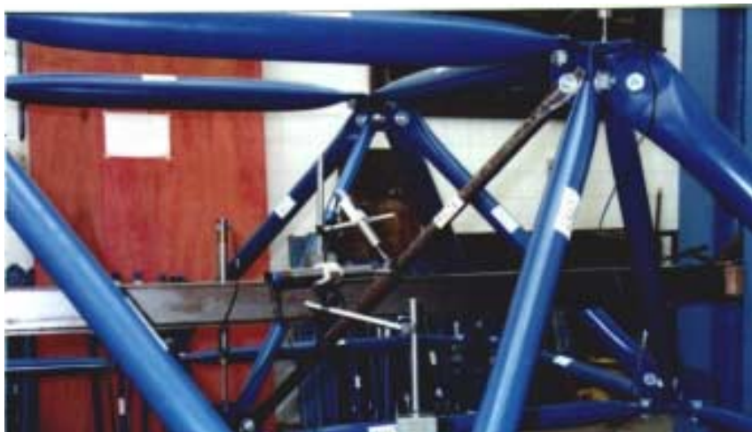
Foto V.10 - Modo de flambagem da barra 9-12, no ensaio 912E.
