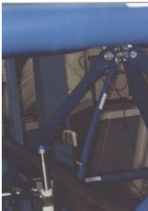
Foto V.4 - Detalhe da curvatura da barra 9-12 devido à flambagem da mesma. Ensaio 912A.
