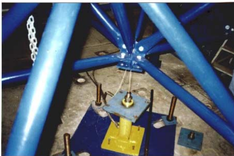
Foto IV.16 – Montagem do sistema de carga e vista do alinhamento do eixo do pistão com o centro do nó 9.
