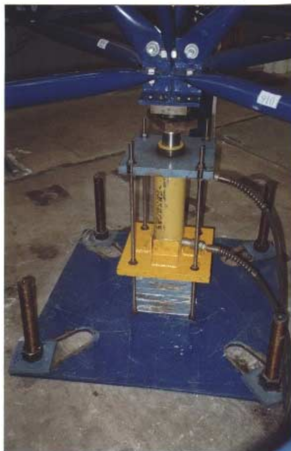
Foto IV.5 – Sistema de aplicação de cargas para o ensaio 912.
