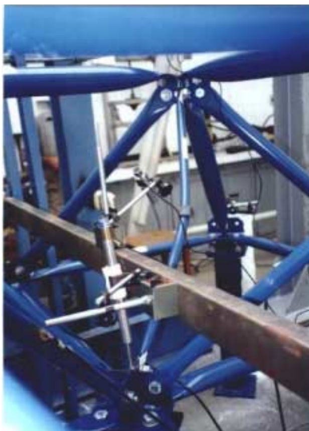
Foto V.7 - Modo de flambagem da barra 9-12 no ensaio 912B.
