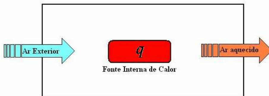
Figura 4.1 - Carga de calor total dentro do espaço ( q )
