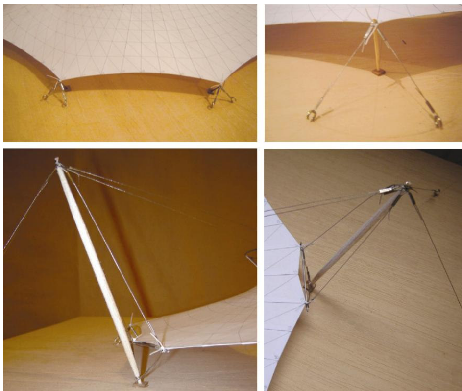
Figura 6.48 - Detalhe pequenos e grandes mastros/ membrana externa Modelo Estudo 2 (2º ajuste) na escala 1/100
