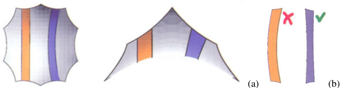
Figura 4.7 – Modulação, corte e planificação da superfície espacial em faixas planas:
