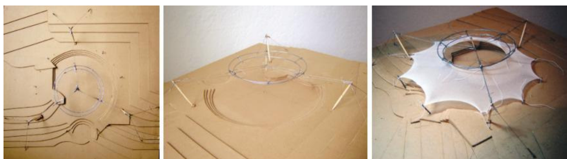
Figura 6.12 - Vistas da montagem modelo flexível Estudo 2 (1º ajuste): do sistema suporte e da membrana externa Escala do modelo 1/200
