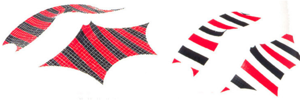
Figura 4.8 – Modulação e padronagem das formas espaciais seguindo as trajetórias geodésicas Fonte: FOSTER, 2004, p.208.
