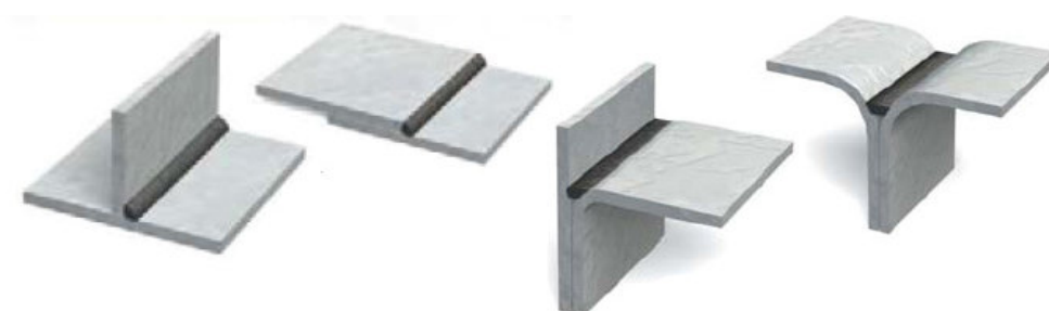
Figura 3.5 - Algumas configurações de solda entre chapas de aço
