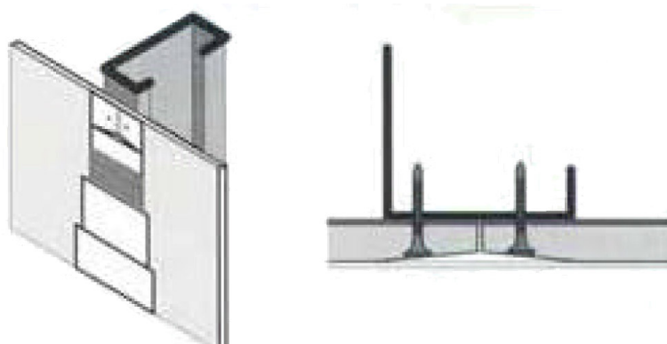
Figura 5.20 - Junta oculta entre placas cimentícias
