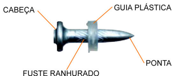
Figura 3.3 - Pino para fixação à pólvora em aço Fonte: HILTI, 2007
