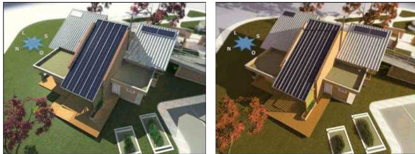
FIGURA 2.21 – Perspectivas da Casa Eficiente mostrando a insolação sobre as fachadas cegas leste e oeste. Fonte: CAPELLO, 2006, p. 40.
