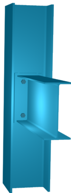
Figura 3.3: Ligação viga-pilar com chapa de topo curta
