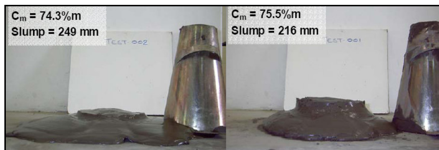
Figura 4.4 – ‘Slump Test’ do overflow de flotação
