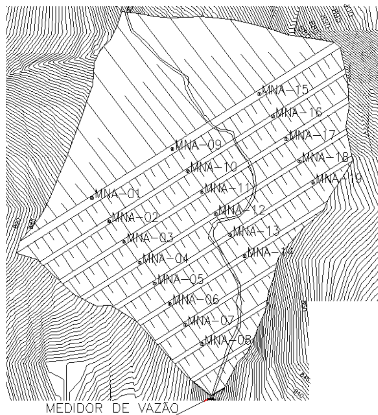
Figura 4.12 – Instrumentação da barragem - medidores de NA e medidor de vazão (CMEC, 2005).
