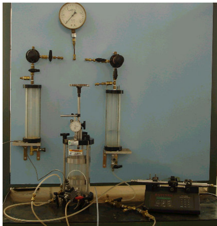
Figura 2.8 – Montagem geral do equipamento tipo HCT.
