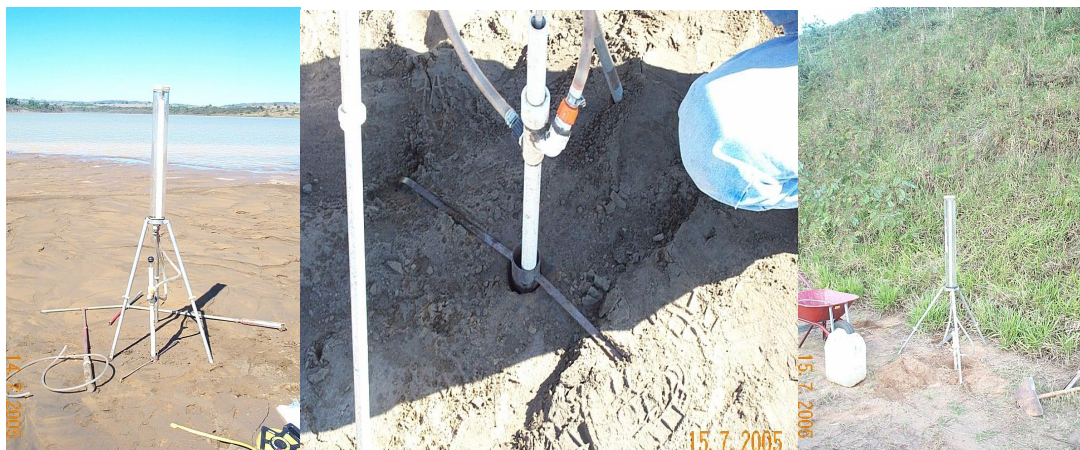
Figura 4.9 – Ensaio de campo com o permeâmetro de Guelph
