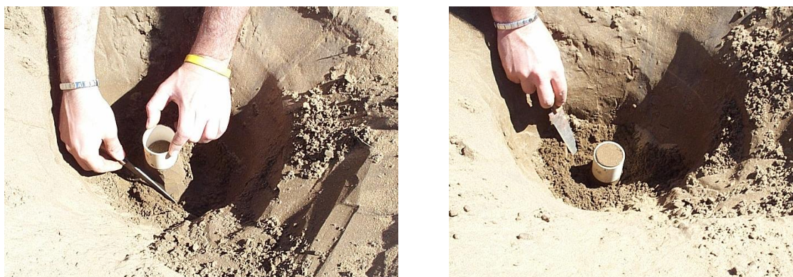
Figura 4.11 – Determinação de densidades “in situ” com o cilindro biselado.
