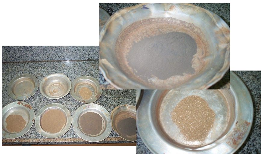
Figura 5.21 – Separação granulométrica da amostra S1-U-A1 (frações retidas na # 60 e na # 325)
