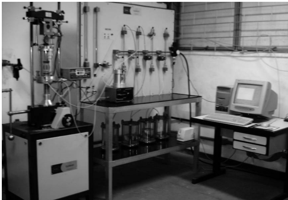
Figura 5.17 – Equipamento triaxial do Laboratório de Geotecnia/UFOP.
