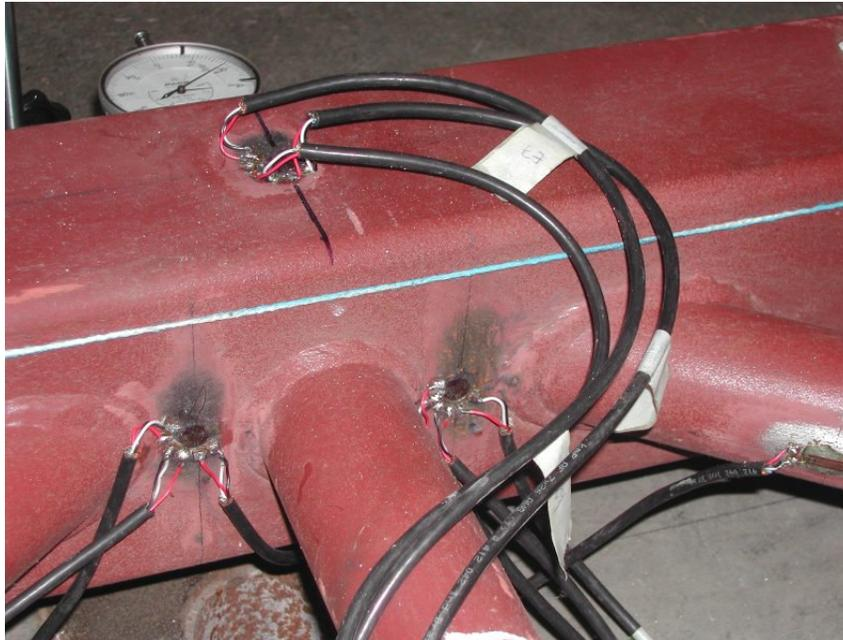
Figura 3.12 Região de instrumentação por roseta de deformação.
