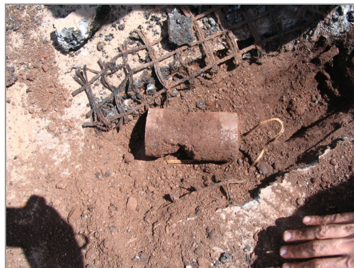
Figura 4. 56 – Retirada do Sensor horizontal da seção 04
