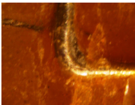
Figura 4. 71 – Ligação da haste com o filamento apresentando desgaste por oxidação
