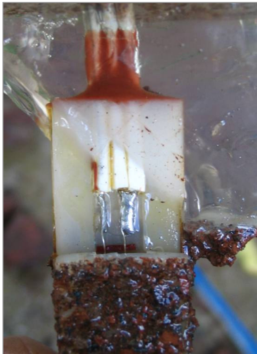
Figura 4. 75 – Detalhe da região interna do sensor (solda) que está engastada na calota de resina superior
