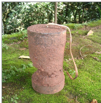
Figura 4. 61 – Corpo de prova retirado da pista com o solo compactado
