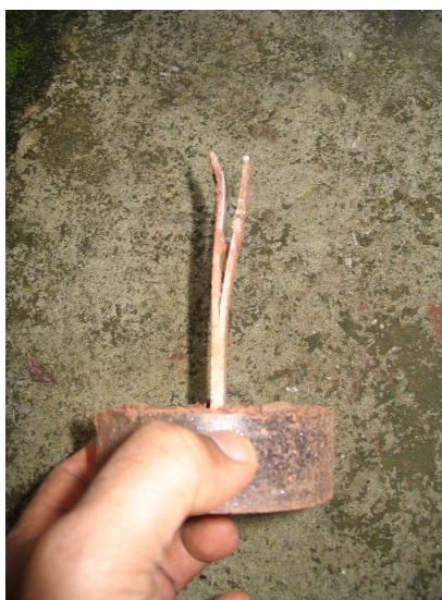
Figura 4. 65 – Sensor exumado com sua estrutura quebrada suas metades descoladas
