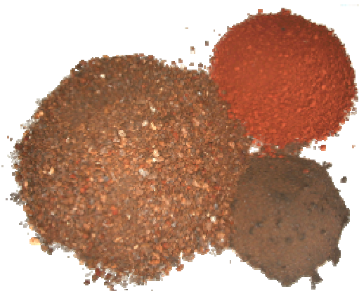
Figura 2. 14 – Traço de 70% de jigite, 20% de argila e 10% de rejeito fino
