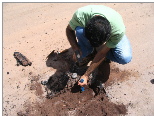
Figura 4. 53 – Escavação da base para a retirada do sensor horizontal
