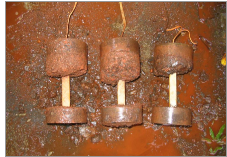
Figura 4. 60 – Corpos de prova com solo enrijecido pela infiltração de resina
