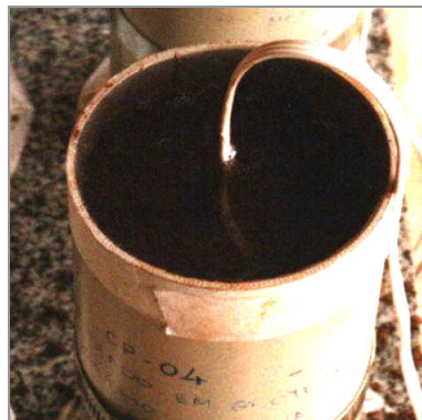
Figura 2.35 – Aplicação da camada de resina do topo
