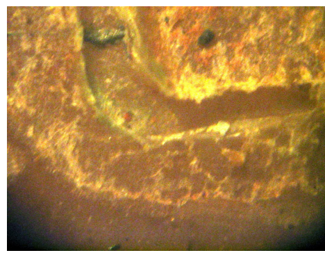
Figura 4. 72 – Haste descolada do filamento da resistência
