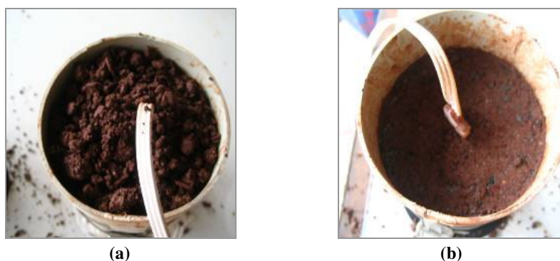
Figura 2 34 – (a) preenchimento da fôrma com solo; (b) camada de solo compactado
