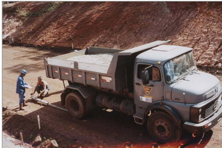
Figura 3. 13 – Ensaio com Viga Benkelman na camada de base
