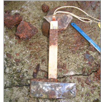
Figura 4. 63 – Corpo de prova com parte da resina retirada do sensor
