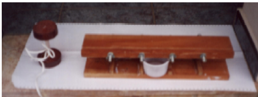
Figura 2.25 – Sensor pronto e montagem utilizada para confecção dos sensores (Fernandes, 2005)
