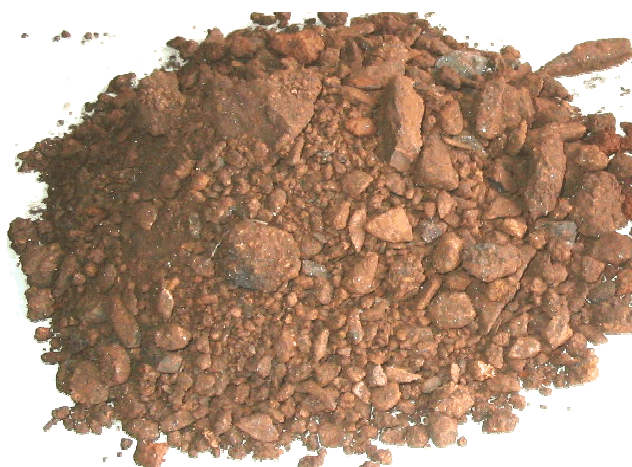
Figura 2. 7 – Cascalho de itabirito – material utilizado na camada de base da seção tipo
