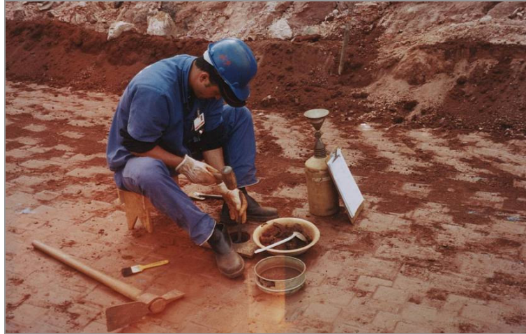
Figura 3. 10 – Ensaio de Frasco de areia
