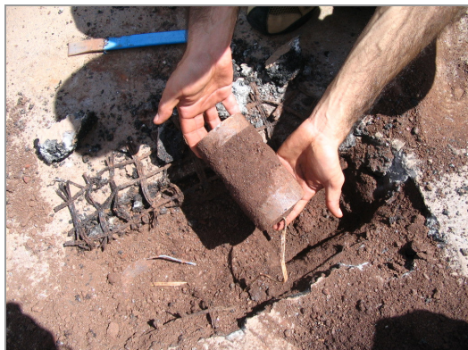
Figura 4. 55 – Retirada do Sensor vertical da seção 04
