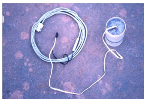
Figura 2. 37 – Instalação completa do sensor, ponte, cabos e conector
