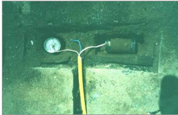
Figura 3.25 – Detalhe dos corpos de prova assentados na base
