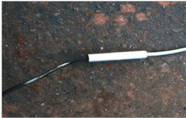
Figura 2. 30 – Detalhe da ponte elétrica blindada
