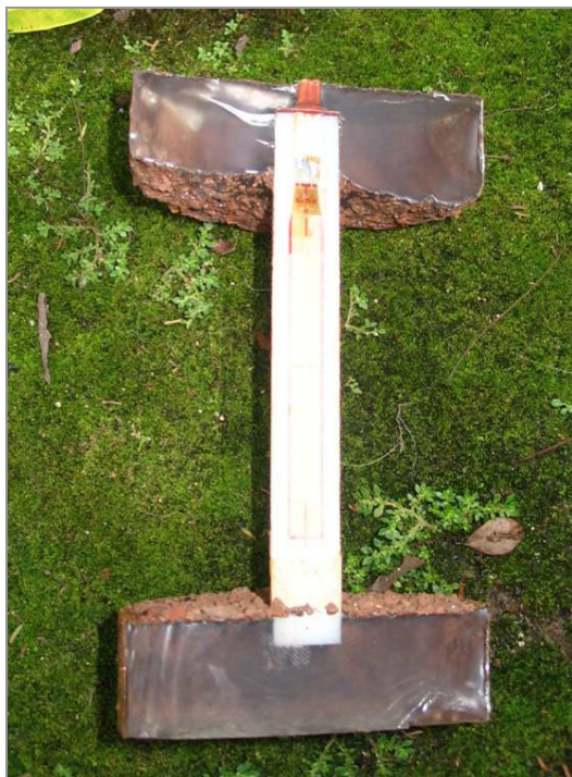
Figura 4. 74 – Sensor exumado partido ao meio para mostrar a posição da resina em relação às suas partes internas
