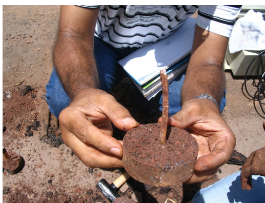
Figura 4. 58 – Detalhe de um sensor vertical quebrado na junção com a resina
