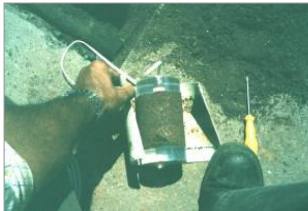
Figura 3.24 – Detalhe da desfôrma do corpo de prova em campo para a sua instalação
