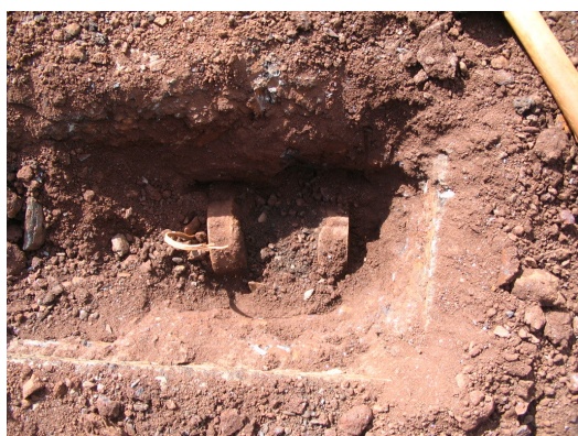
Figura 4. 57 – Sensor horizontal da seção 02 mostrando-se bastante deformado
