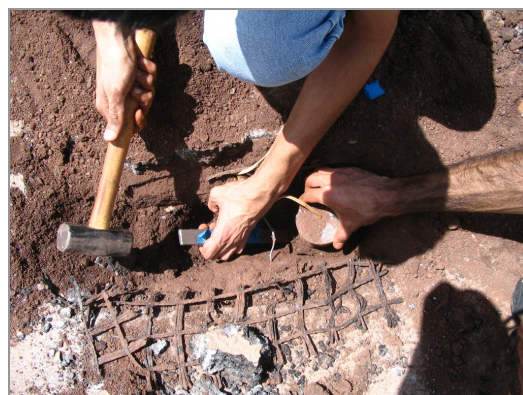
Figura 4. 54 – Escavação da base para a retirada do sensor vertical
