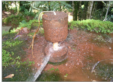
Figura 4. 59 – Corpo de prova sendo lavado para a retirada do solo
