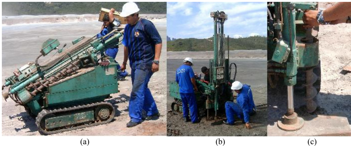
Figura 3. 4 – (a) Máquina de cravação, (b) montagem do equipamento e, (c) detalhe da ancoragem
