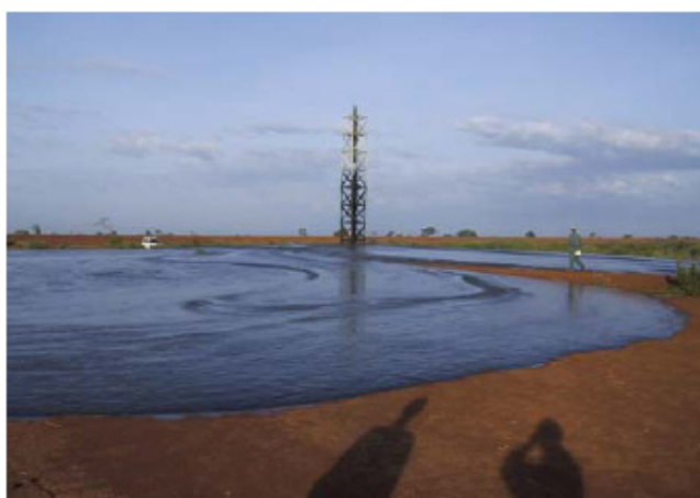
Figura 2. 8 – Rejeitos recentemente lançados (Theriault et al., 2003)
