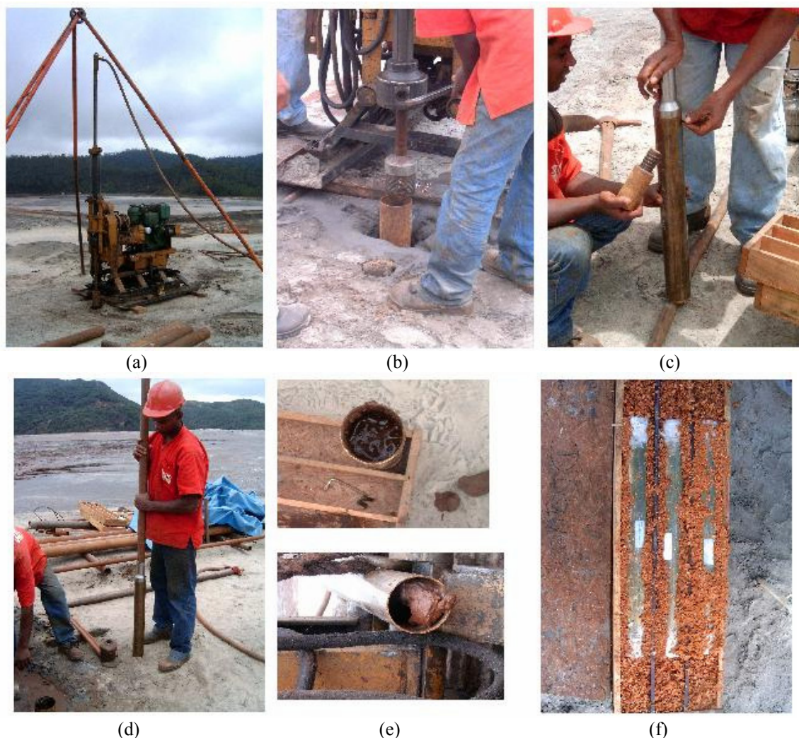
Figura 3. 9 – Amostragem tipo Shelby, (a) equipamento de sondagem mista utilizado no avanço da sondagem, (b) detalhe do tubo de revestimento, (c) amostrador Shelby, (d) montagem do amostrador, (e) amostras coletadas e, (f) acondicionamento dos sheldies nas caixas com as camisas envoltas com serragem úmida
