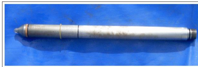
Figura 3. 5 – Piezocone utilizado no ensaio de campo
