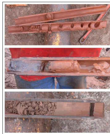
Figura 4.4 – Amostras deformadas retiradas dos ensaios de sondagem (Observe a variedade dos materiais encontrados)
