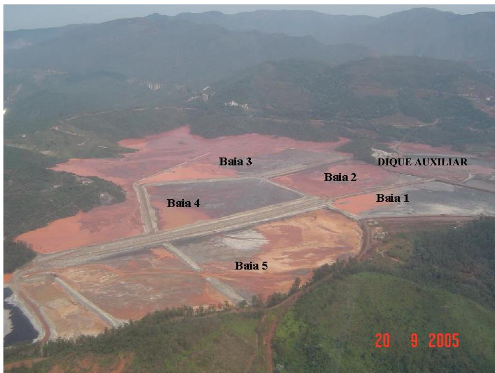
Figura 3. 1— Baias de ressecamento (depósitos) na barragem de Germano, da Samarco Mineração S.A.
