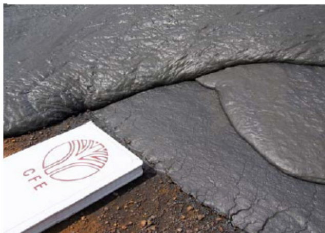
Figura 2. 7 – Disposição de finas camadas de rejeitos em pasta (Theriault et al., 2003)
