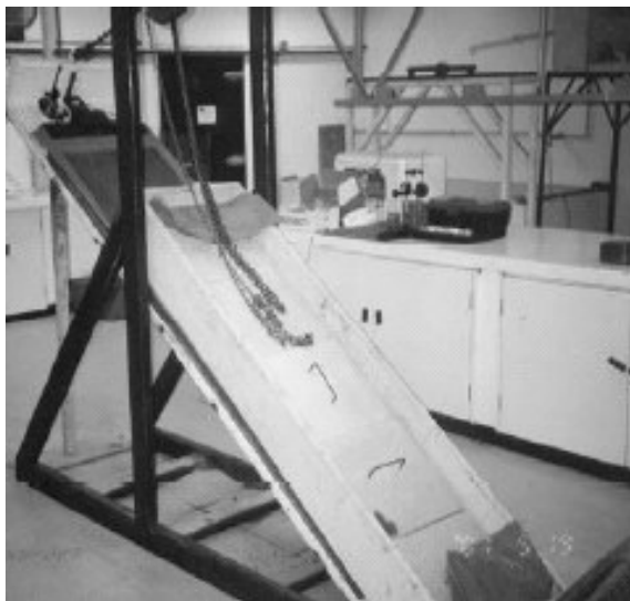
a) – Ensaio de plano inclinado (Mello, 2001)
